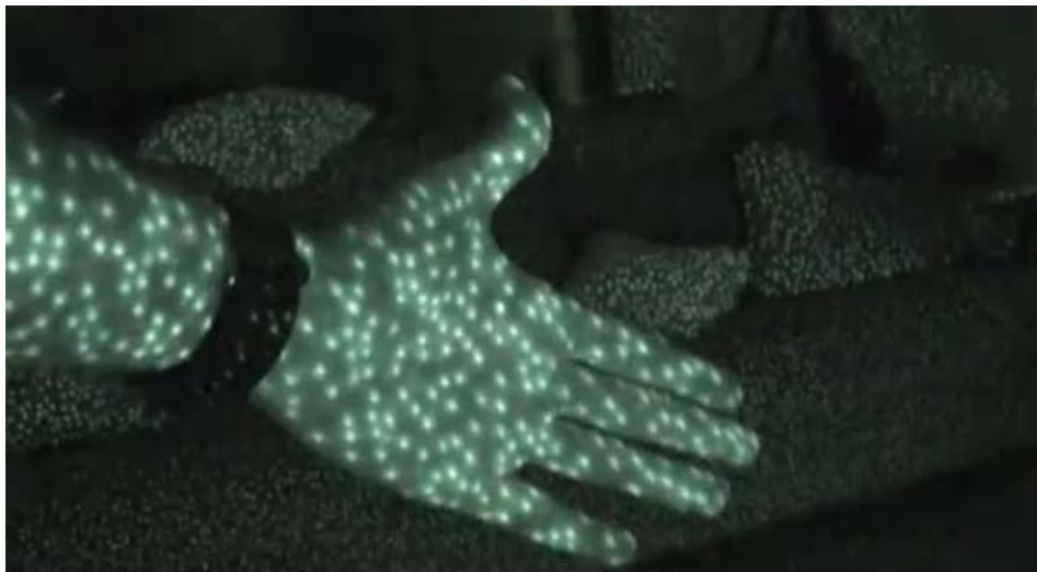
Figura 5 - Representação do sensor de profundidade do Kinect
