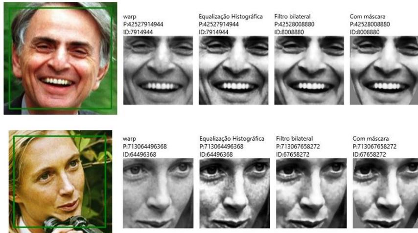
**Figura 18** – Pré-processamentos realizados sobre duas faces detectadas (a esquerda). O primeiro é as transformações geométricas, em seguida equalização por histograma em três partes, após filtro bilateral e por fim aplicação de máscara elíptica. Fonte: do autor.
