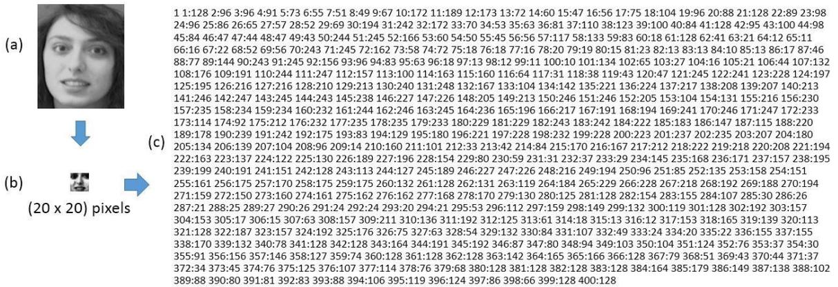
**Figura 21** – Transformação de imagem contendo a face em um vetor de *features*. (a) Imagem original. (b) Face extraída e pré-processada. (c) Vetor de *features* gerado a partir de (b). O primeiro caractere, “1”, é o valor do *label* para a imagem. Em seguida, cada pixel da imagem é numerado sequencialmente de acordo com sua posição, e o valor de cada pixel é escrito a direita de sua coluna correspondente, separado por dois pontos. Fonte: do autor.
