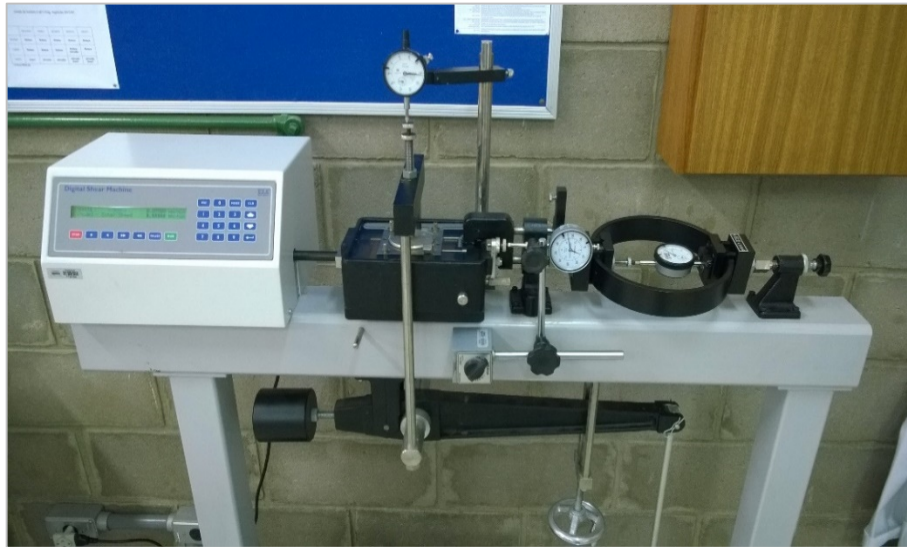
Figura 15 - Equipamento utilizado nos ensaios de cisalhamento direto
