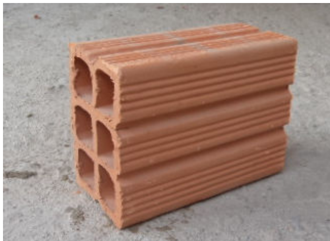
Figura 15 – Bloco de 6 furos de vedação utilizado no empreendimento
