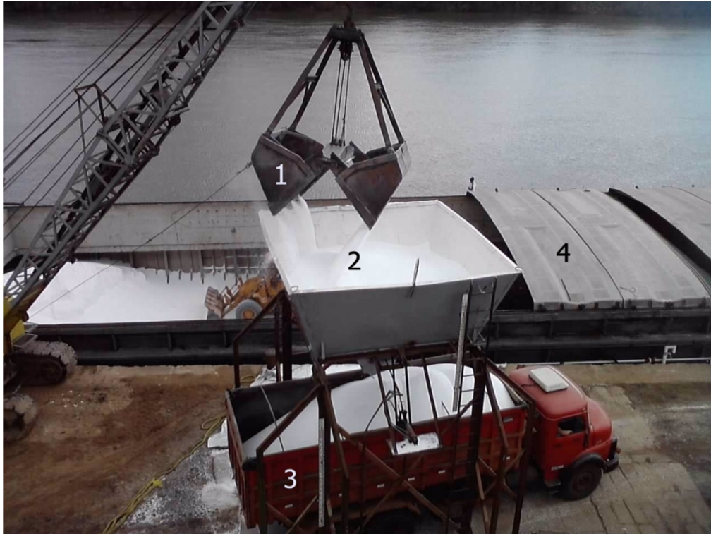
Figura 20 - Descarga de uma embarcação para veículo rodoviário
