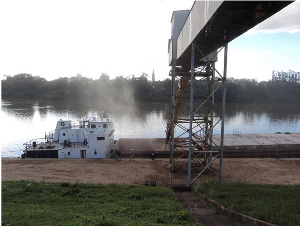
Figura 27 - Poluição do ar por dispersão de material pulverulento durante a carga de embarcação
