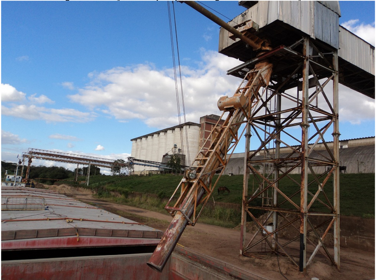
Figura 19 - Lança telescópica para carregamento de embarcações
