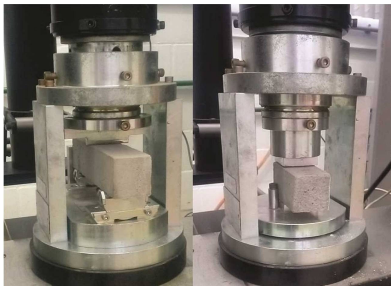
Figura 10 - Ensaio de tração na flexão e compressão axial
