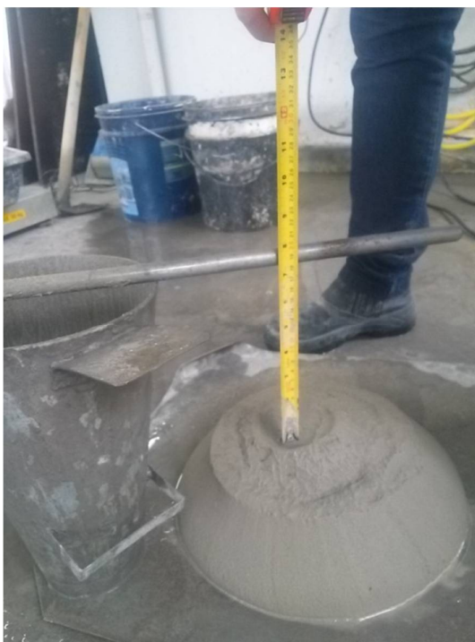
Figura 12 - Ensaio de SLUMP
