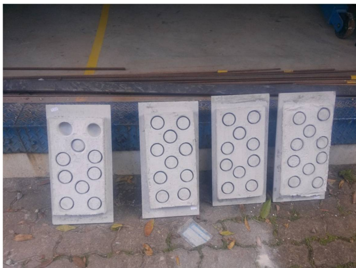
Figura 16 - Placas com corpos-de-prova para ensaio de arrancamento
