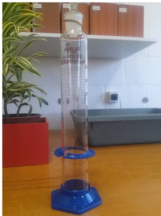
Figura 7 - Proveta graduada para ensaio de teor de ar incorporado
