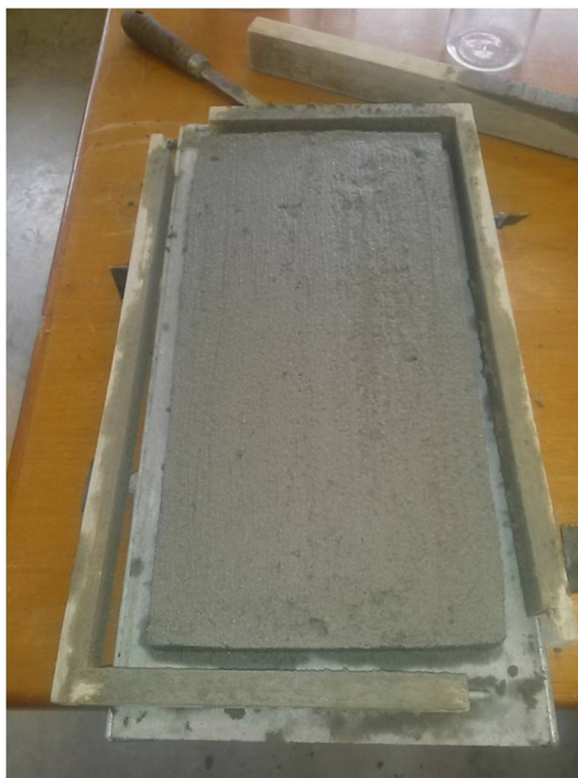
Figura 15 - Placa para ensaio de arrancamento
