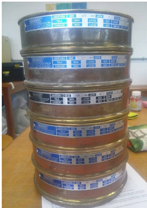
Figura 3 – Série de peneiras utilizadas na caracterização da areia
