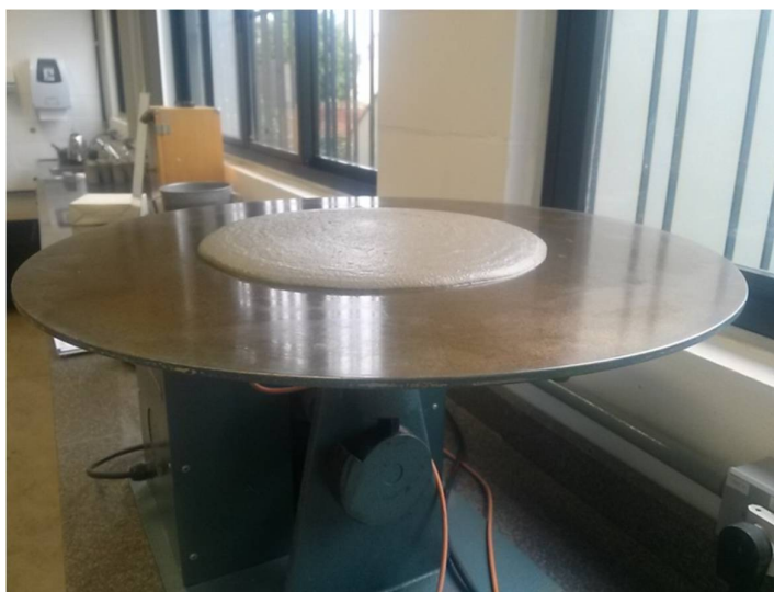
Figura 6 - Ensaio de consistência da argamassa
