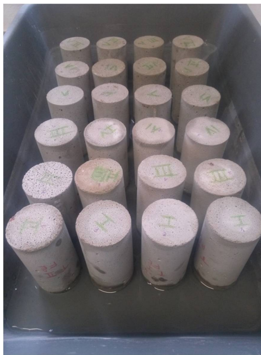
Figura 9 - Ensaio de absorção de água por capilaridade
