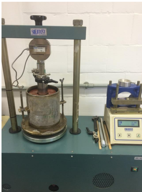
Figura 24 - Corpo de prova na prensa CBR/Marshall
