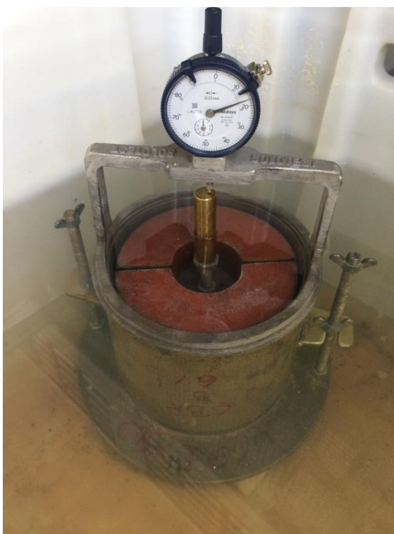
Figura 23 - Corpo de prova em imersão após 4 dias
