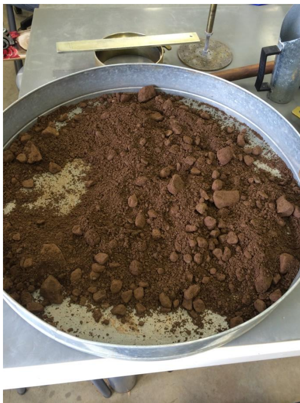
Figura 20 - Mistura de composição granulométrica com água
