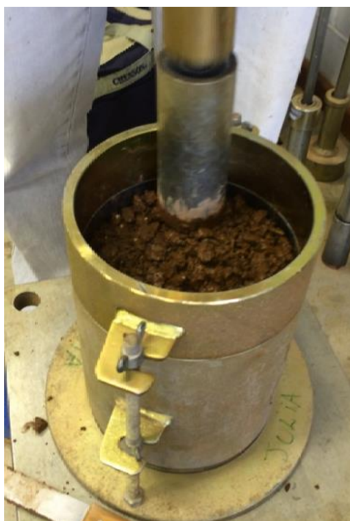
Figura 22 – Compactação do corpo de prova
