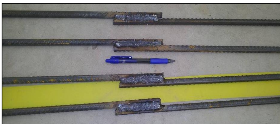
Figura 46 - Barras diâmetro 12,5mm soldadas primeiro conforme modelo 02, e na sequência conforme modelo 03.
