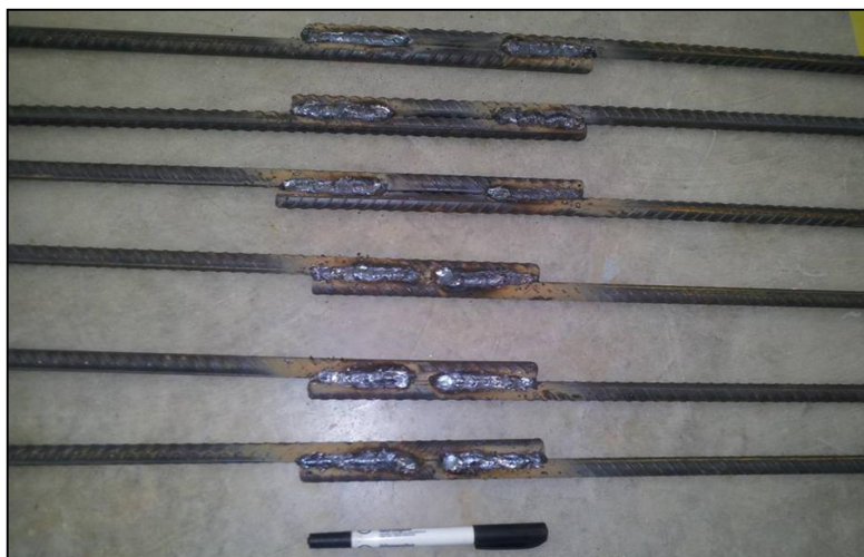
Figura 43 - Barras diâmetro 12,5mm soldadas primeiro conforme a norma, e na sequência conforme primeiro modelo proposto.
