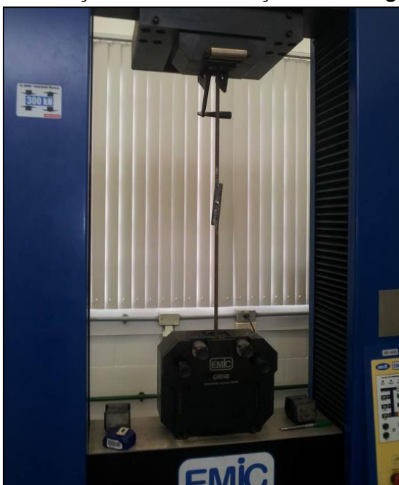
Figura 47 - Realização de ensaio de tração em uma ligação soldada.
