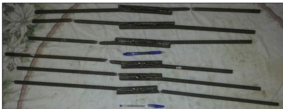
Figura 51 - Emendas conforme a norma e conforme modelo 01 para barras diâmetro 12,5mm
