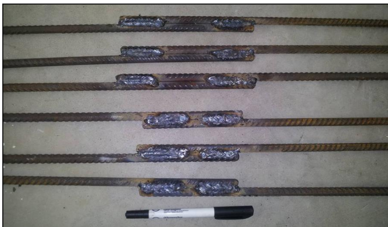
Figura 42 - Barras diâmetro 10mm soldadas primeiro conforme a norma, e na sequência conforme primeiro modelo proposto.
