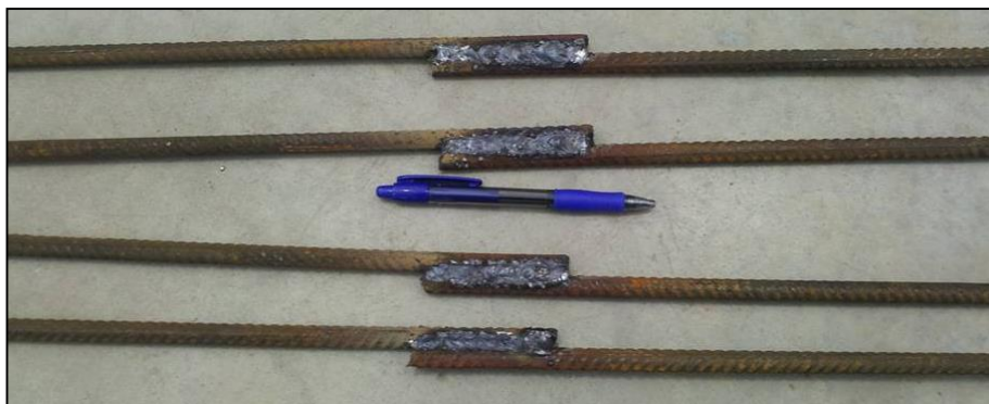
Figura 44 - Barras diâmetro 8mm soldadas primeiro conforme modelo 02, e na sequência conforme modelo 03.
