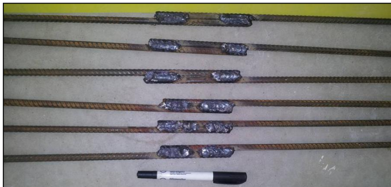
Figura 41 - Barras diâmetro 8mm soldadas conforme a norma, e na sequência conforme primeiro modelo proposto.
