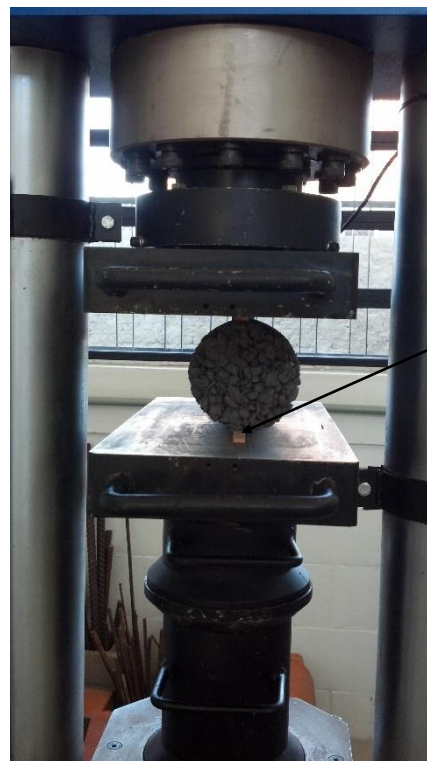
Figura 13 Corpo de prova devidamente colocado para o teste de tração na compressão diametral.
