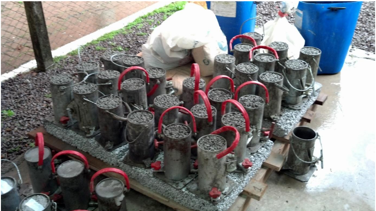
Figura 10 Alguns dos corpos de prova cilíndricos ainda nas formas, logo após a moldagem.
