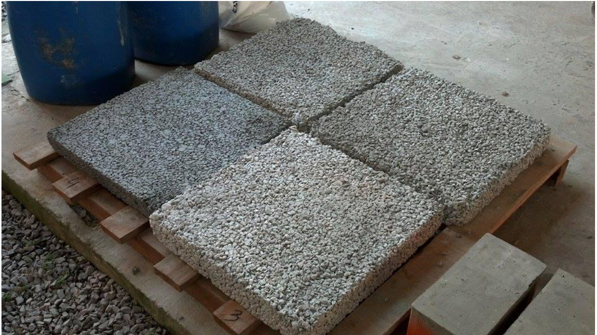
Figura 11 Placas utilizadas no ensaio de permeabilidade.
