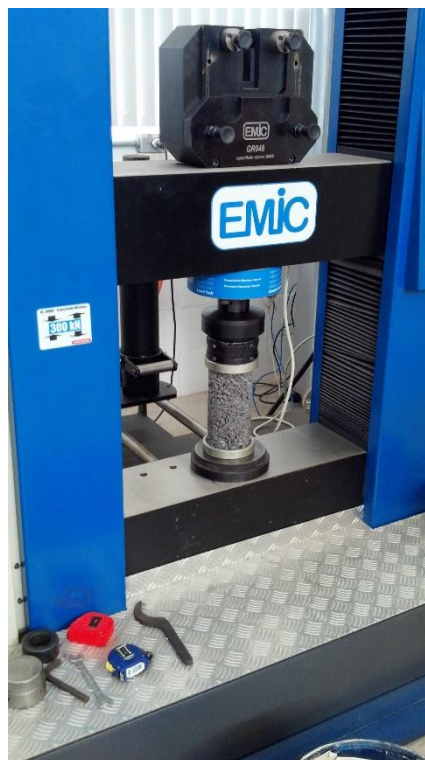
Figura 12 Corpo de prova devidamente posicionado para o ensaio de compressão.
