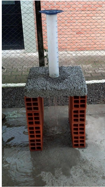
Figura 15 Ensaio de permeabilidade sendo executado.
