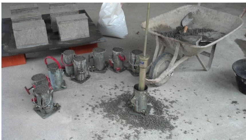
Figura 9 Compactação do corpo de prova cilíndrico com o soquete Marshall.
