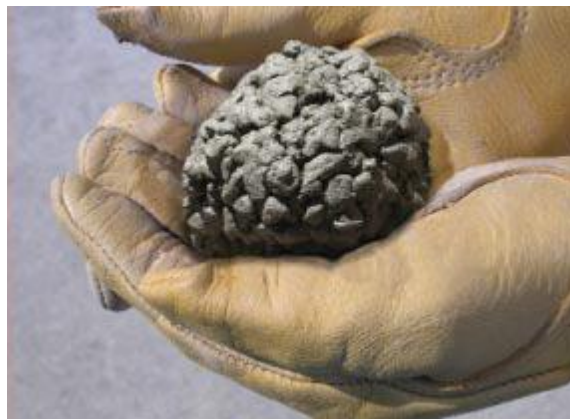
Figura 8 Consistência do concreto permeável
