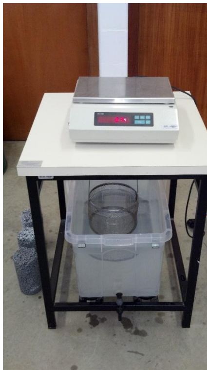
Figura 14 Aparelhagem para medição do peso seco e do peso submerso.
