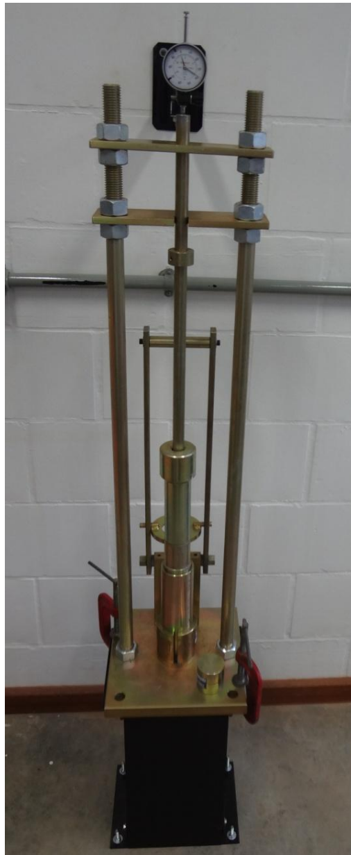
Figura 20 – Equipamento para a Compactação Mini-MCV.
