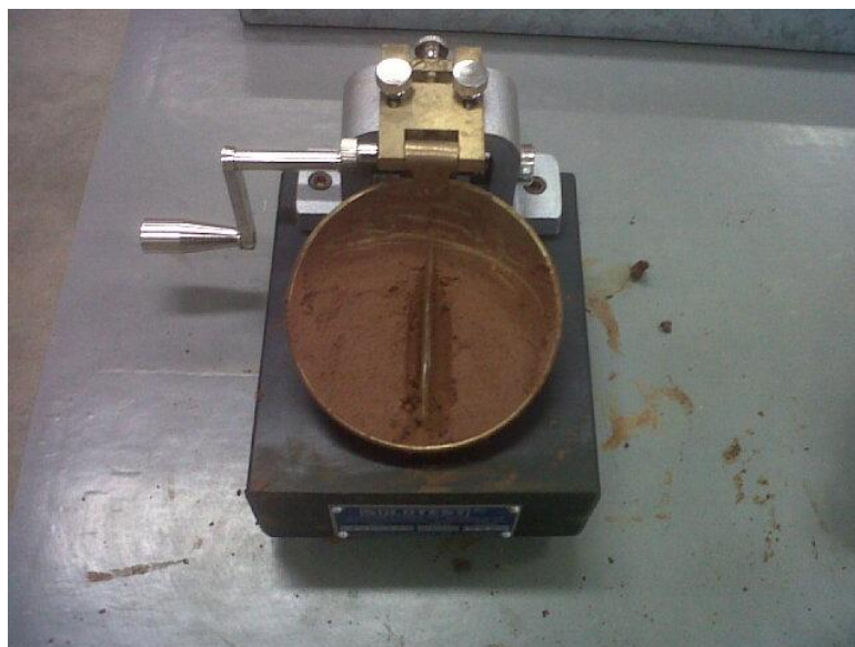
Figura 12 – Aparelho de Casagrande, determinação do Limite de Liquidez.
