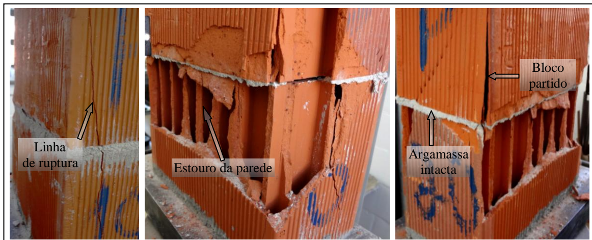
Figura 36 - Rompimentos típicos da junta Tipo 5
