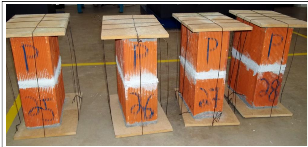
Figura 39 - P25 ao P28 travados por chapas
