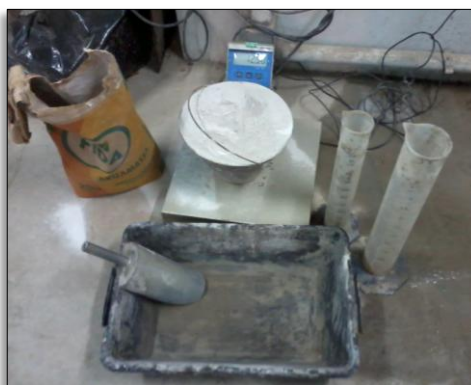
Figura 14- Preparo da argamassa
