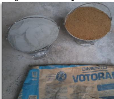
Figura 10- Traço da argamassa de capeamento
