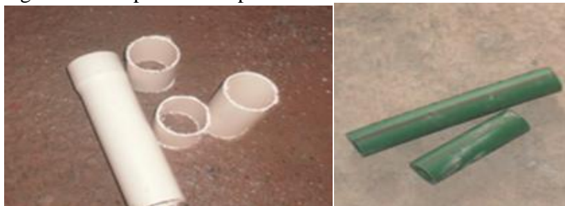
Figura 53: Desperdício na parte hidráulica.
