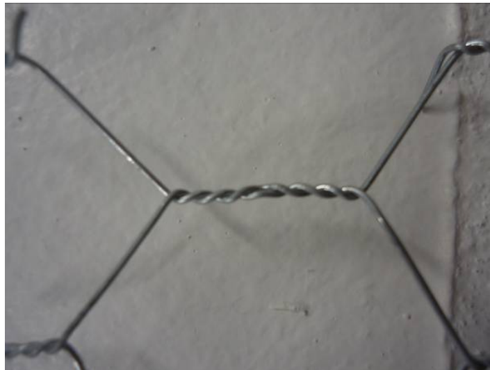
Figura 29 – Fios trançados do Modelo T-Hex.
