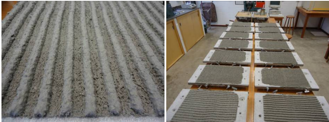
Figura 23 – Chapisco executado nas placas de ensaio.
