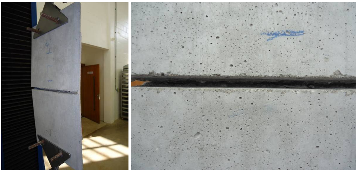
Figura 75 – Ruptura no lado posterior da placa revestida.
