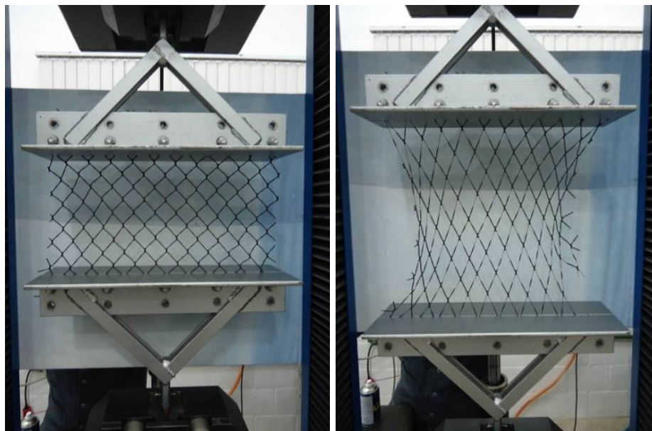
Figura 50 – Ensaio de tração da tela do Modelo T-PVC, direção vertical.
