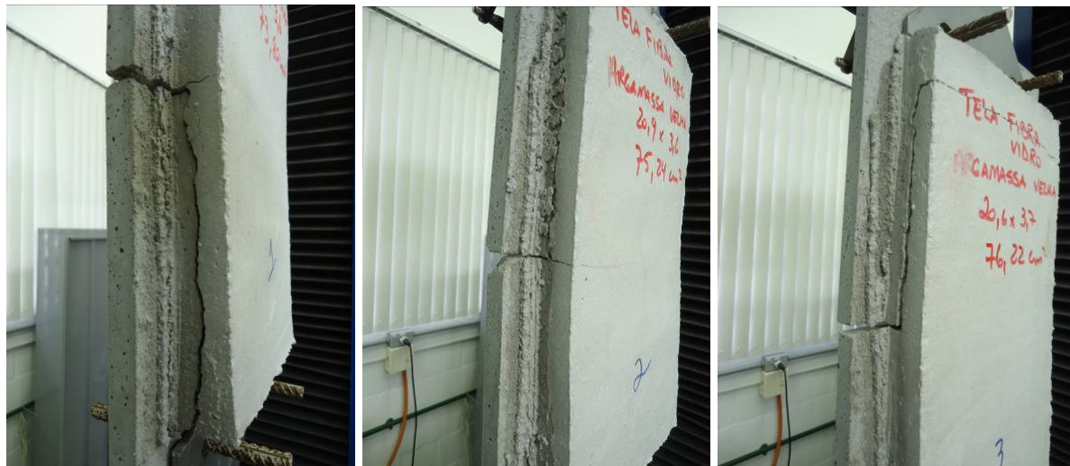
Figura 81 – Corpos de prova rompidos – Modelo T-FV.
