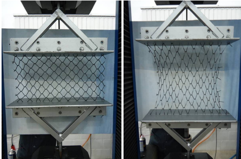
Figura 51 – Ensaio de tração da tela do Modelo T-PVC, direção horizontal.
