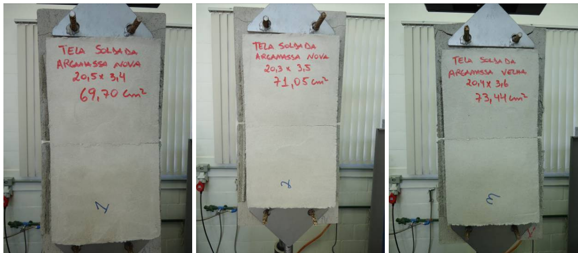
Figura 74 – Corpos de prova rompidos – Modelo T-Elet.
