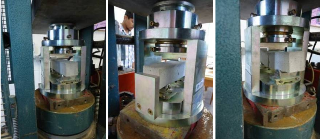
Figura 20 – Ensaio de tração na flexão, lote T3-08032014.
