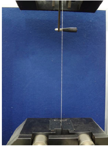
Figura 34 - Ensaio de tração, fio componente do Modelo T-FV.
