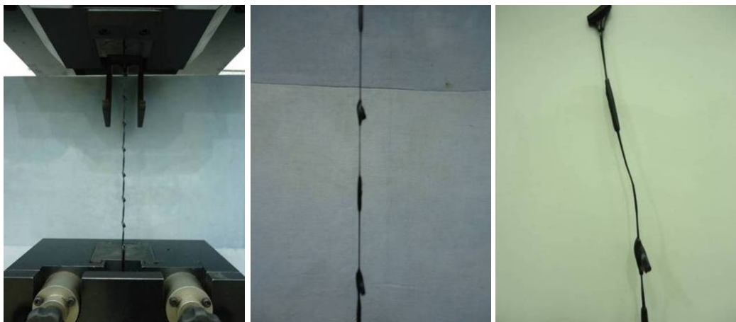
Figura 37 - Ensaio de tração, fio componente do Modelo T-PVC.
