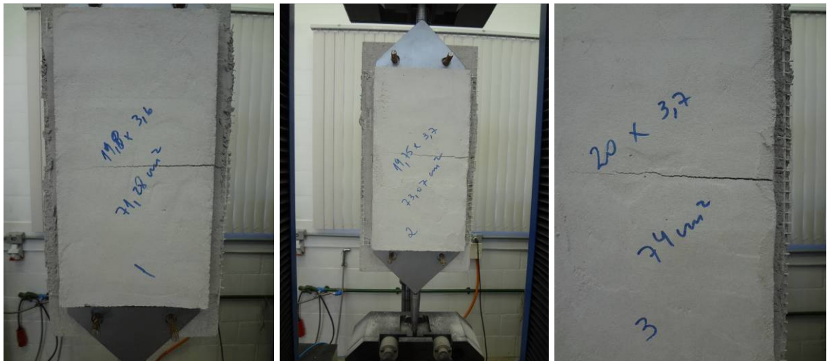
Figura 69 – Corpos de prova rompidos – Modelo T-FV.
