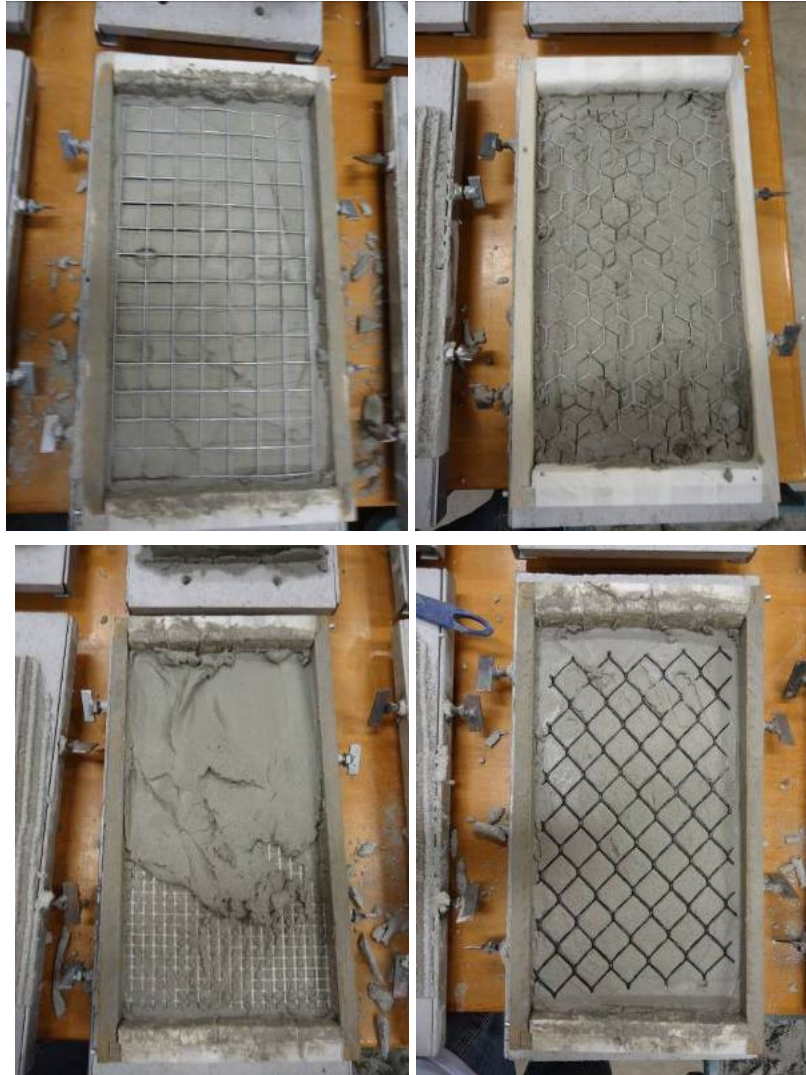
Figura 60 – Posição das telas como estruturação do revestimento.
