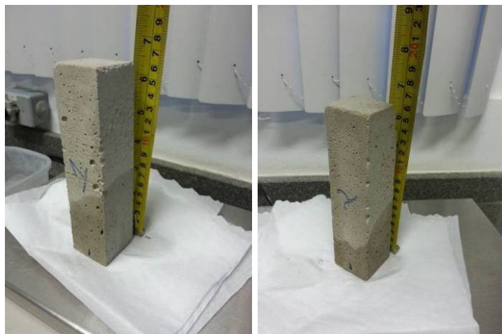
Figura 21 – Ensaio de capilaridade, ascensão da umidade.
