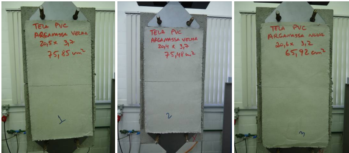
Figura 84 – Corpos de prova rompidos – Modelo T-PVC.
