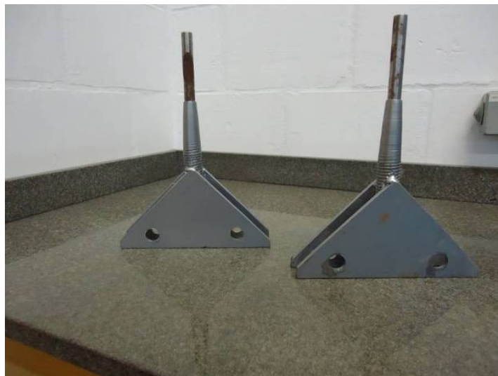
Figura 52 – Suporte para fixação das placas na máquina de ensaio.
