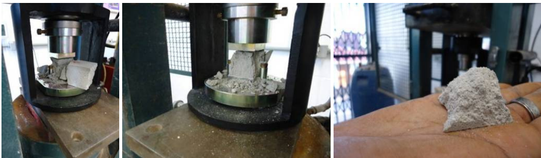
Figura 19 – Ensaio de compressão, lote T3-08032014.
