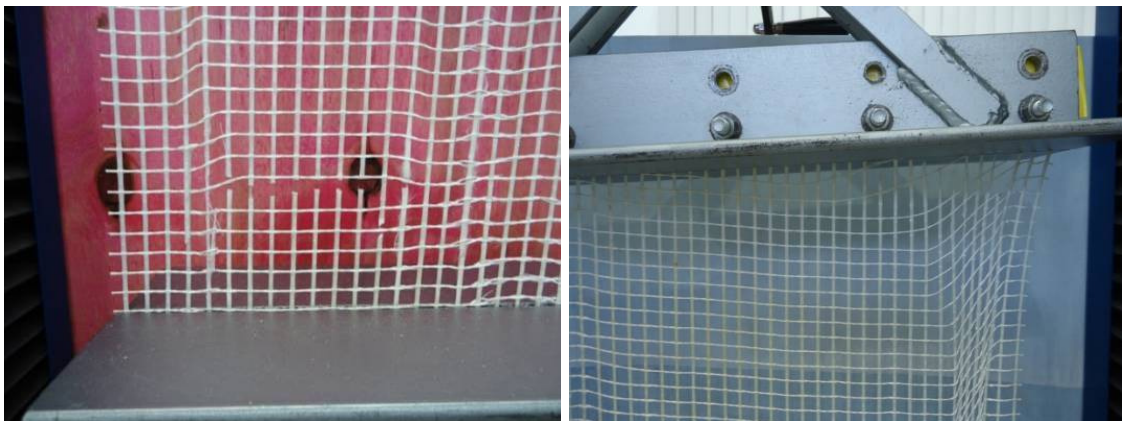
Figura 47 – Ensaio de tração da tela do Modelo T-FV.
