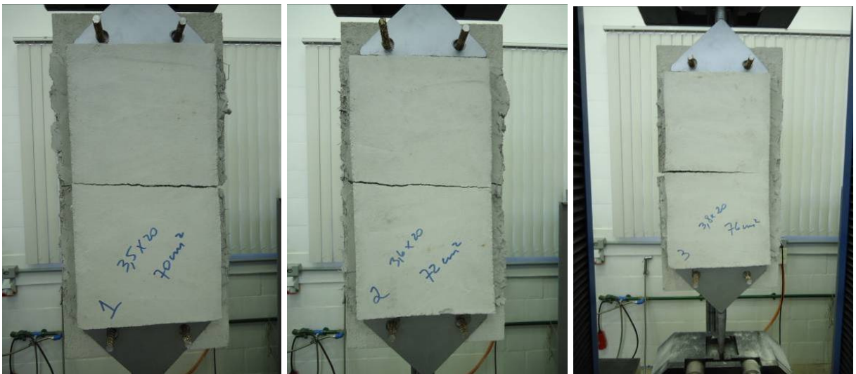
Figura 66 – Corpos de prova rompidos – Modelo T-Hex.
