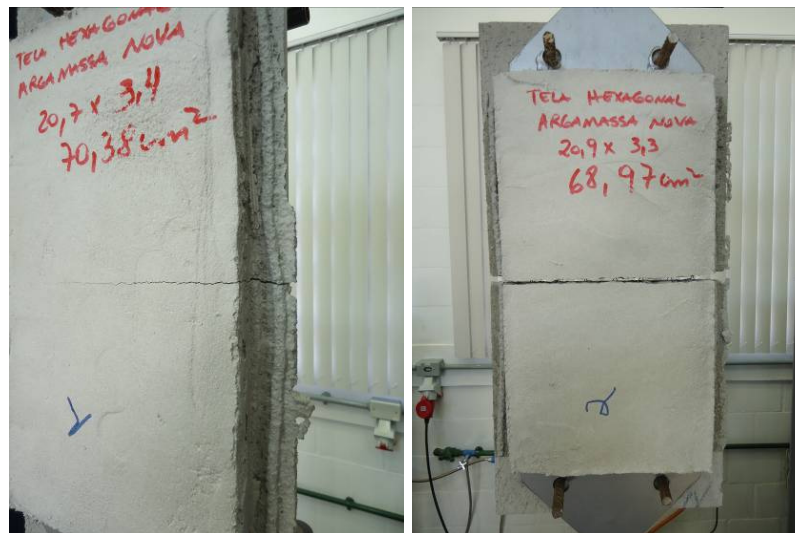
Figura 77 – Corpos de prova rompidos – Modelo T-Hex.
