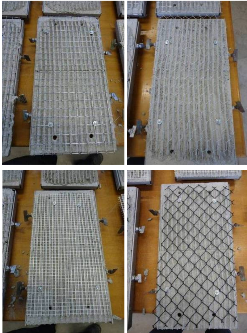
Figura 58 – Telas fixadas nas placas.
