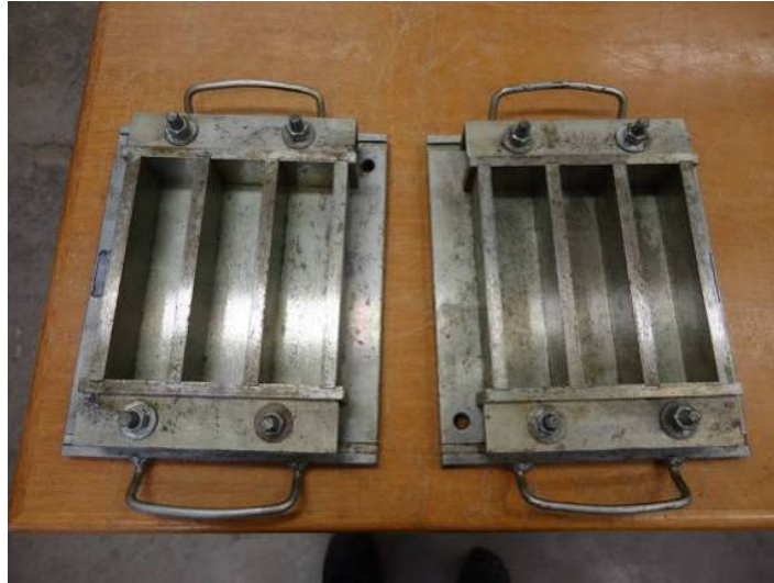
Figura 16 – Fôrmas para moldagem de CP 4cm x 4cm x 16cm.
