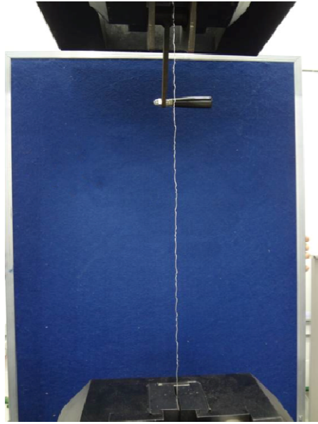
Figura 31 - Ensaio de tração, fio retirado do Modelo T-Hex.
