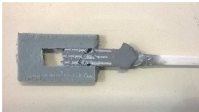
Figura 20: Fio de fibra de vidro descolado do suporte.
