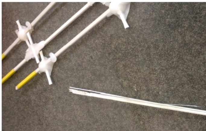
Figura 17: Fio de fibra de vidro esmagado e quebrado nas extremidades.
