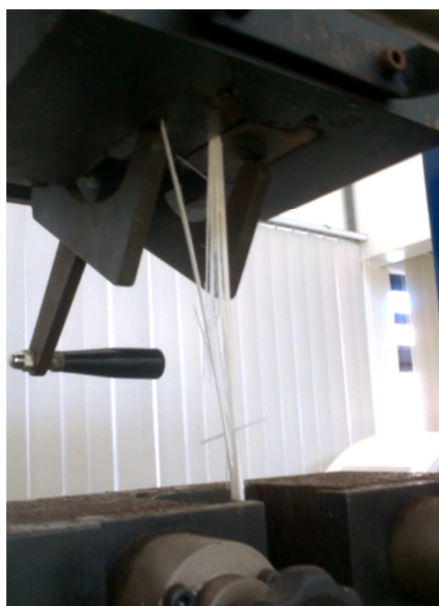
Figura 22: Fio de fibra de vidro atingindo resistência máxima.
