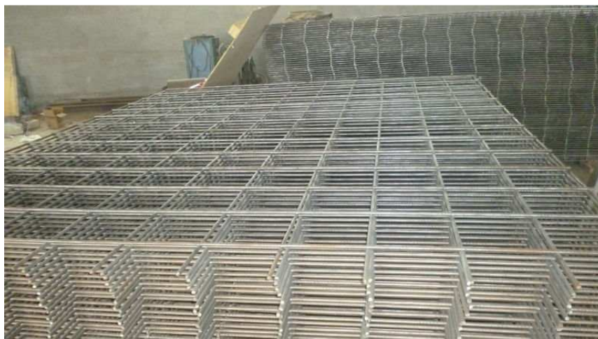
Figura 7: Armadura metálica eletrosoldada.
