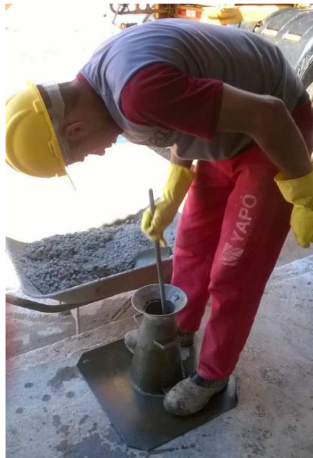
Figura 33: Ensaio de abatimento do tronco cone.
