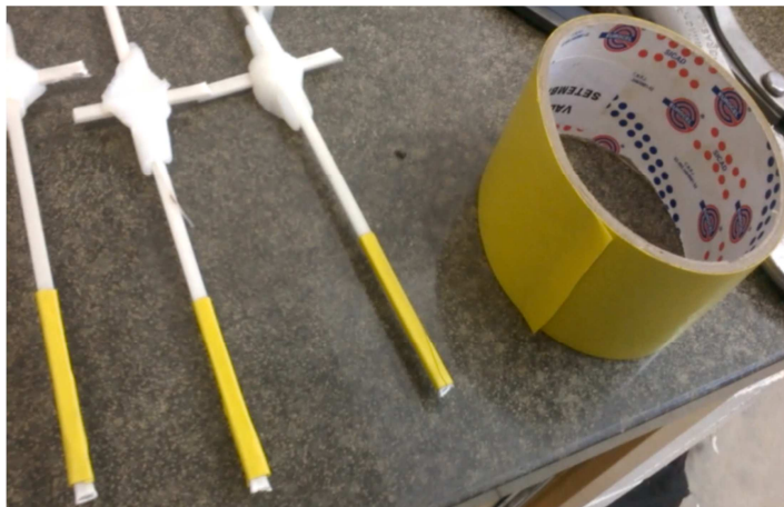
Figura 16: Fios de fibra de vidro cobertos por fita isolante nas extremidades.
