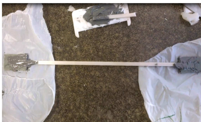
Figura 19: Fio de fibra de vidro com suporte plástico nas extremidades.
