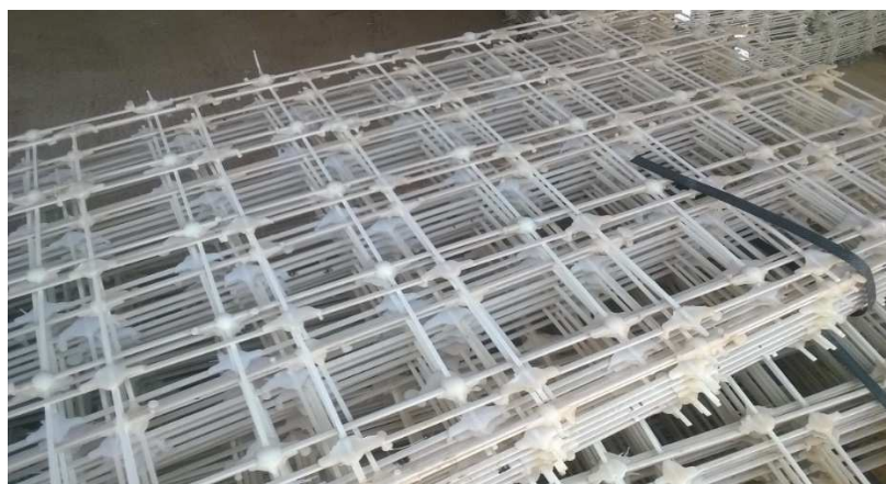
Figura 25: Armadura de fibra de vidro coberta por poliéster.
