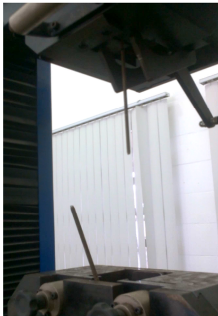
Figura 23: Fio de aço atingindo resistência máxima.
