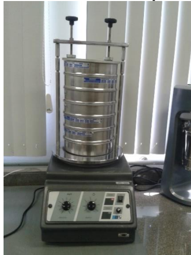
Figura 12 - Realização da etapa de peneiramento com o auxílio do agitador mecânico de peneiras
