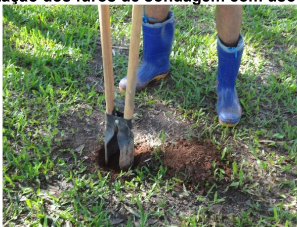
Figura 6 - Realização dos furos de sondagem com uso do trado manual
