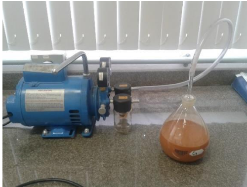
Figura 11 - Retirada do ar do interior do picnômetro com a bomba de vácuo
