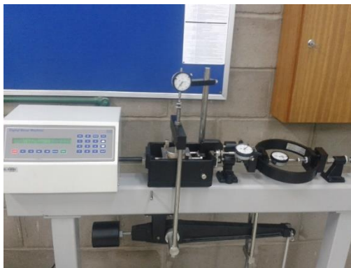
Figura 17 - Conjunto do equipamento constituído de caixa de cisalhamento, anel dinamométrico para aplicação de carga e extensômetros
