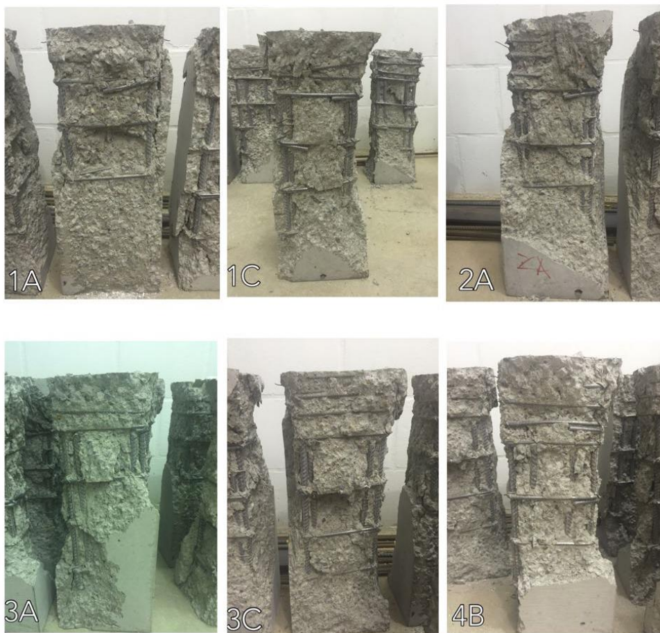
Figura 52 – Protótipos pós ensaio de compressão centrada
