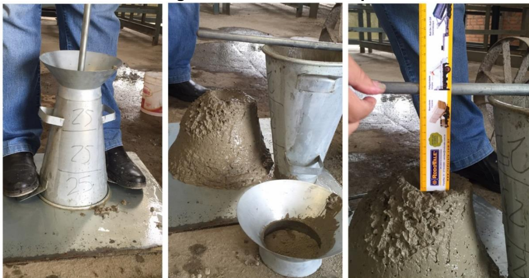
Figura 29 – Teste de Slump
