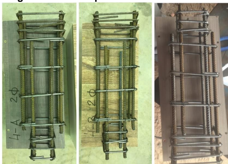
Figura 38 – Pilar tipo 4 – Barras afastadas 2Ø
