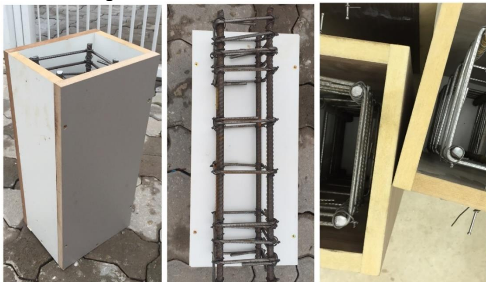
Figura 33 – Formas de MDF e armaduras
