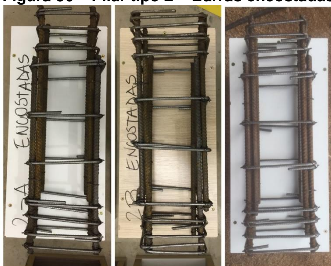
Figura 36 – Pilar tipo 2 – Barras encostadas
