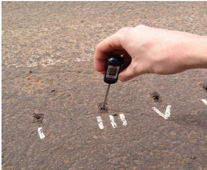
Figura 14 - Coleta da temperatura no revestimento do pavimento a 3 cm de profundidade
