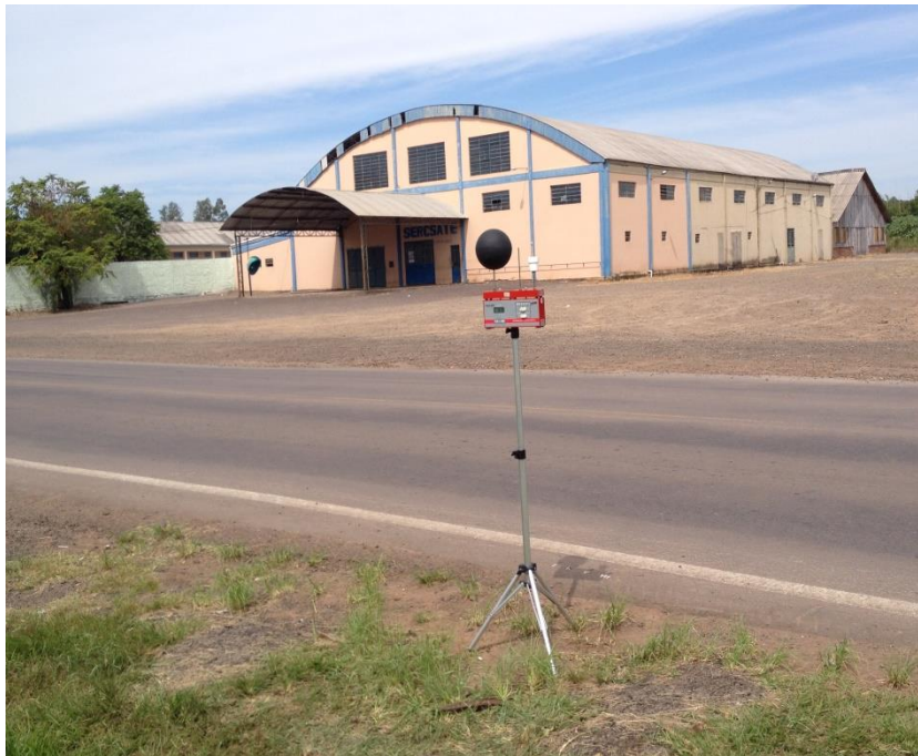
Figura 20 – Termômetro montado e instalado com o auxílio de um tripé para fins de levantamento
