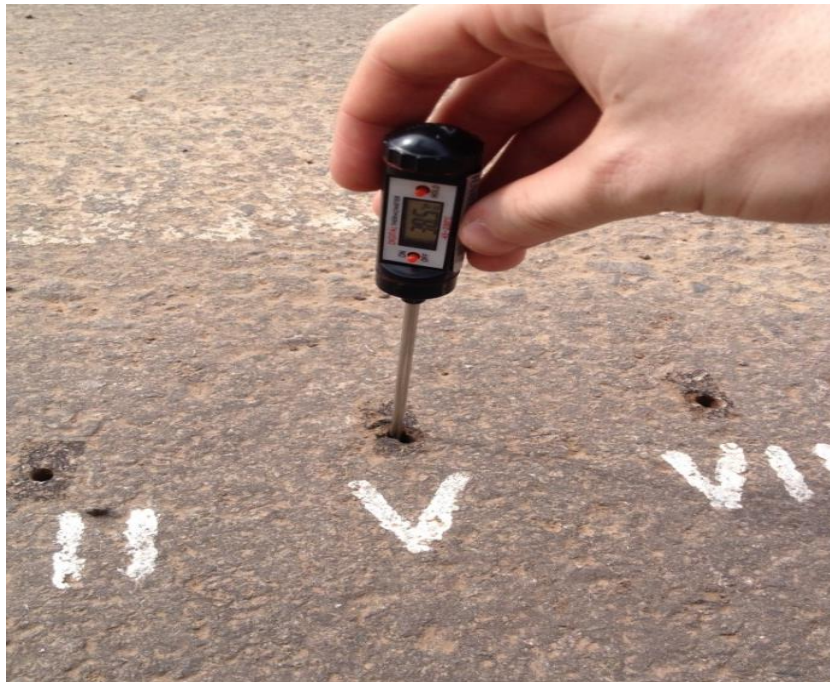
Figura 15 - Coleta da temperatura no revestimento do pavimento a 5 cm de profundidade
