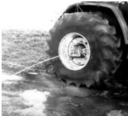
Figura 10 – Adição de 50% de água, bico na posição mediana do pneu
