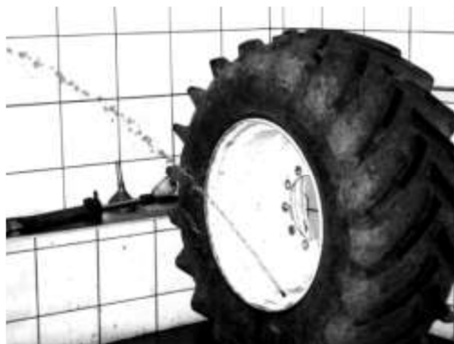
Figura 11 – Adição de 25% de água, bico na posição inferior do pneu
