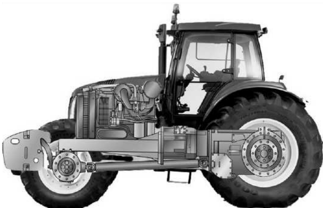
Figura 1- Esquema de um trator 4x2 TDA
