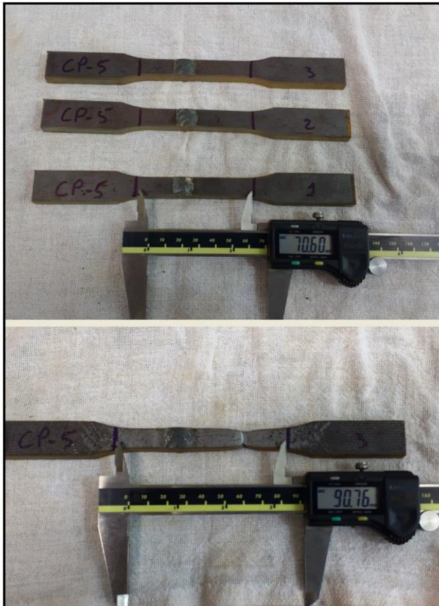
Figura 42 - Medida dos corpos de prova antes e depois do ensaio.
