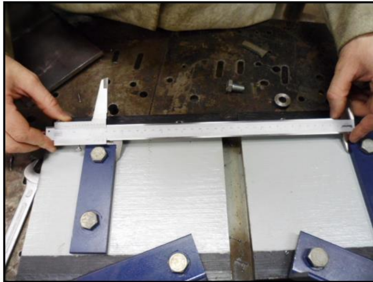
Figura 29 - Medição do gabarito de soldagem.
