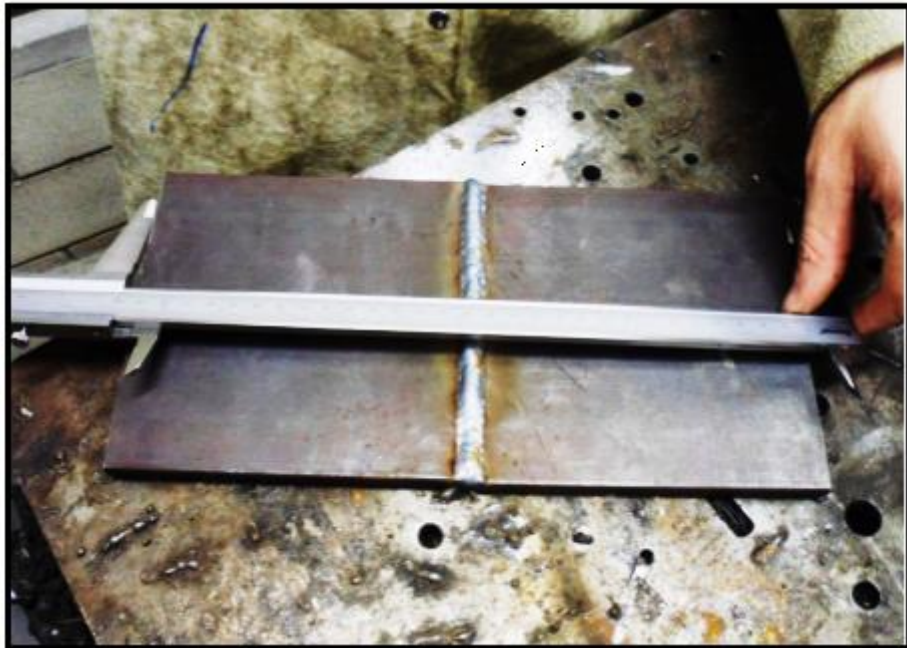
Figura 32 - Inspeção visual da solda e de medias.
