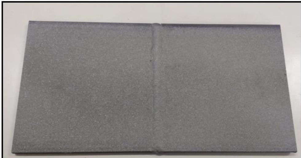
Figura 36 - Peça jateada por granalha de 0,7mm.
