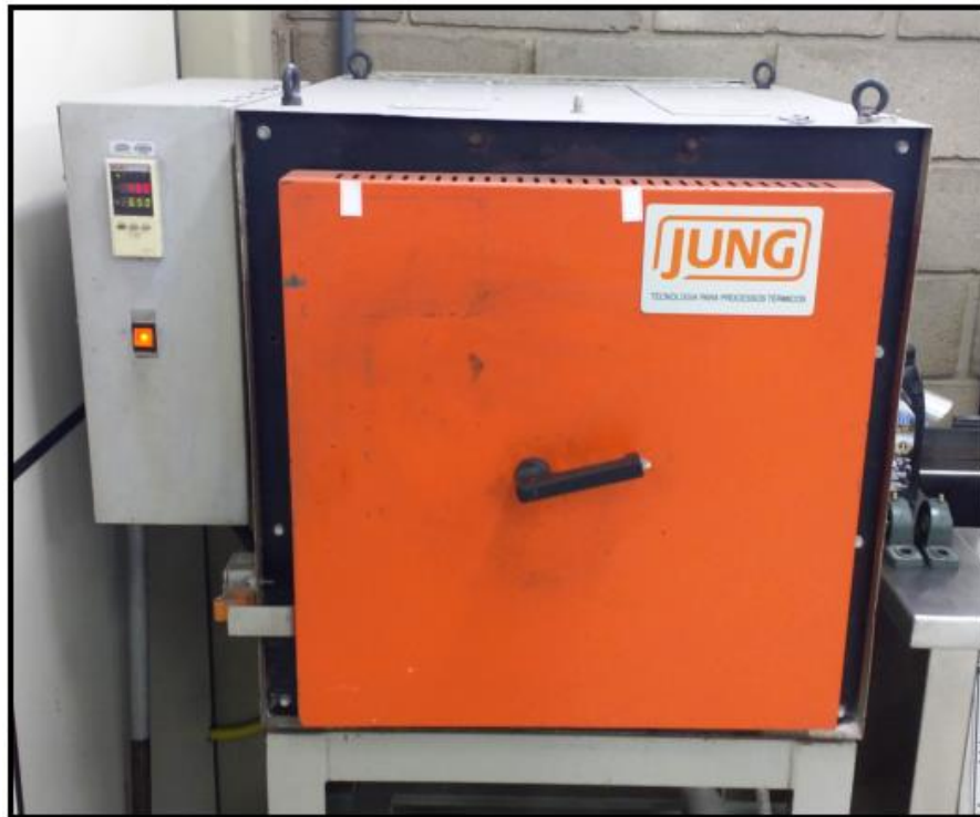
Figura 38 - Forno com temperatura controlada a 650°C para alívio de tensões.
