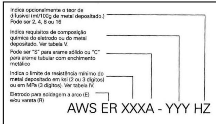
Figura 13 - Nomenclatura para arames eletrodos conforme norma AWS.
