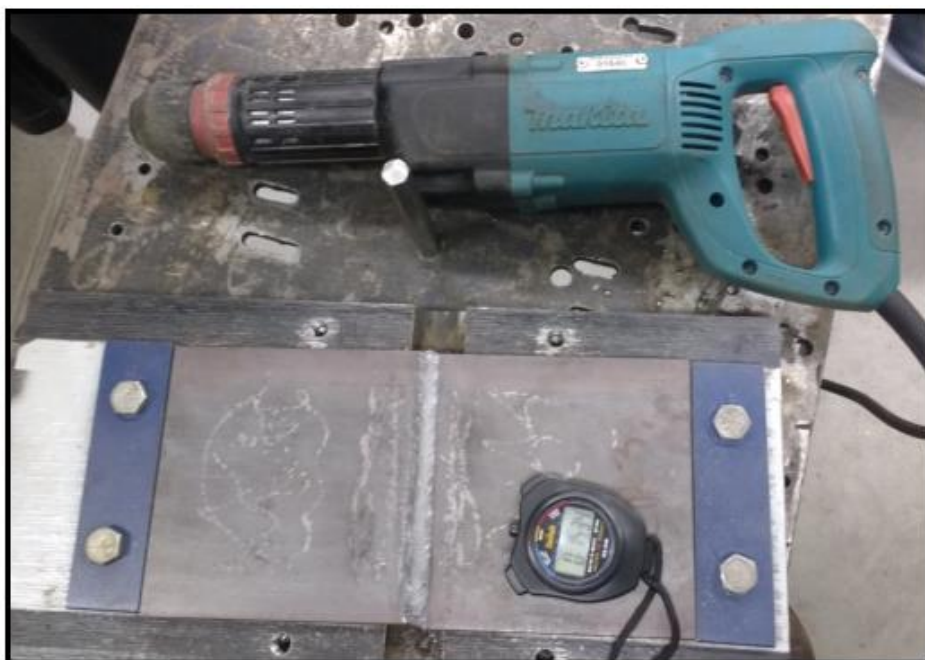
Figura 34 - Martelo rompedor elétrico e ponteira utilizada no processo.
