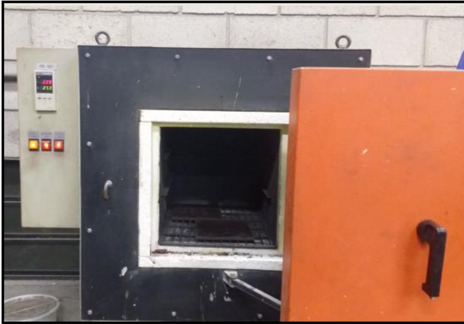
Figura 37 - Forno com temperatura a 250°C para alívio a baixa temperatura.
