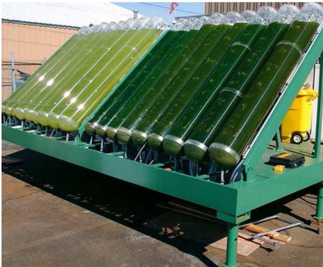
Figura 3: Fotobiorreator tubular verticalmente inclinado para o cultivo fechado de microalgas ( http://www.organicmechanic.com/product/algae-biofuel ).
