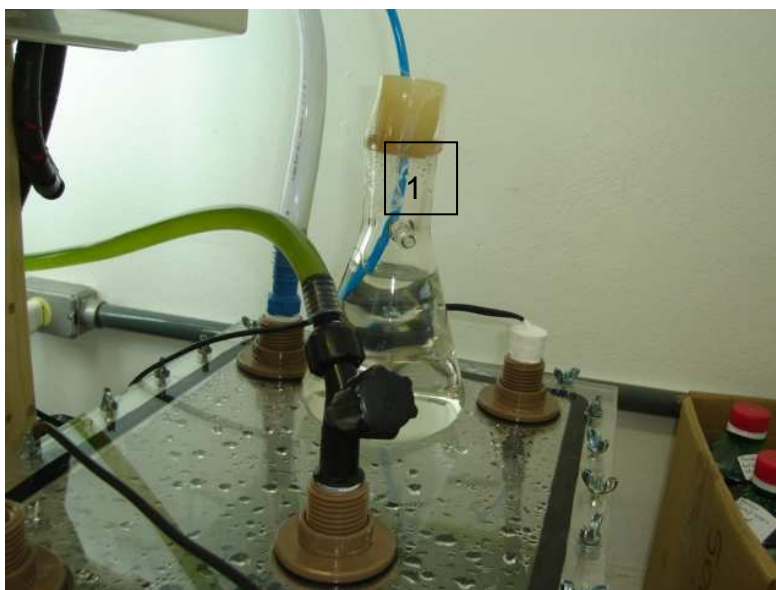
Figura 28: Erlenmeyer ( Trap ) com solução alcalina (1) para fixação do \text{CO}_2 não absorvido pelo sistema.
