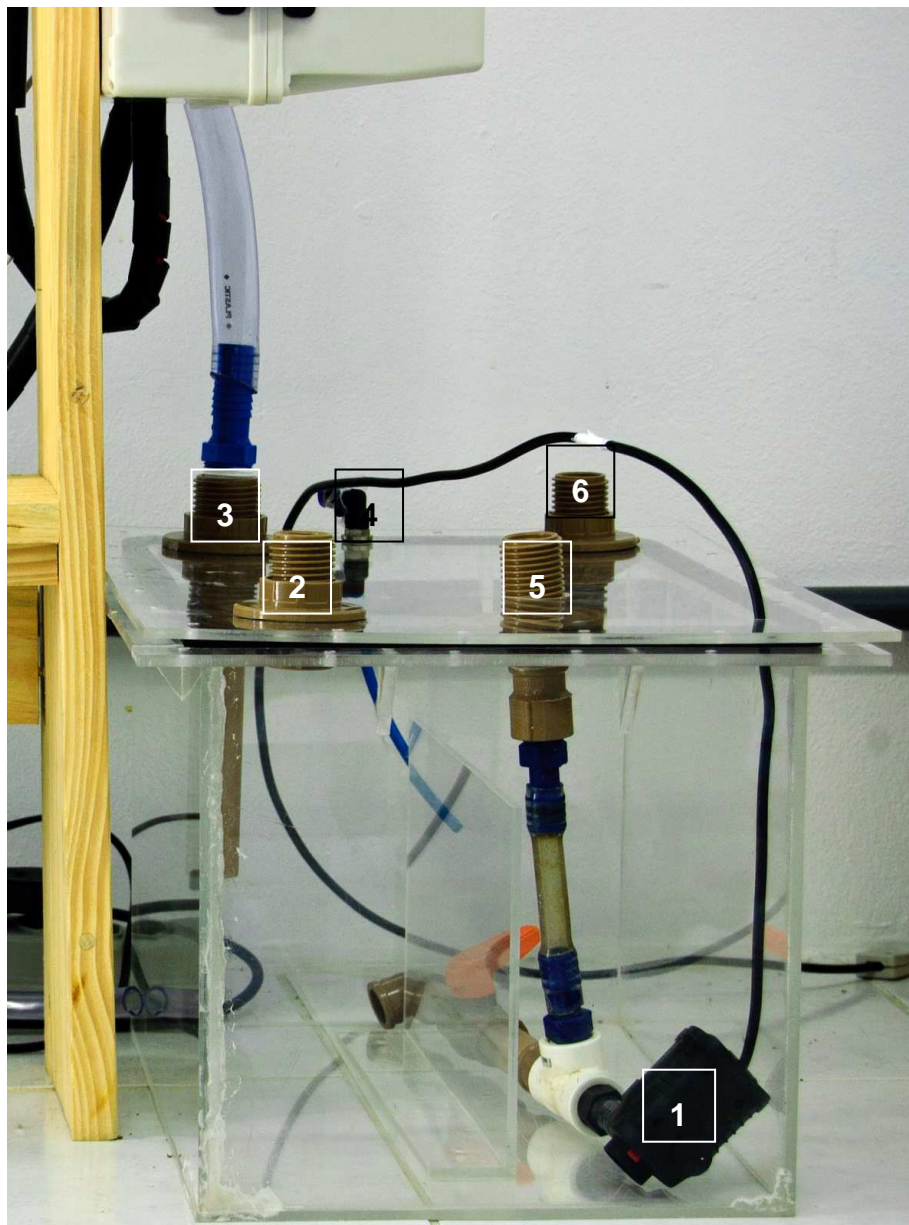
Figura 23: Vista geral do reservatório (caixa de acrílico) construído. A numeração indica as partes constituintes do sistema: (1) bomba submersa; (2) flange para acoplamento de eletrodo (pH); (3) flange para entrada do volume da cultura pós tubos; (4) “engate rápido” de mangueira pneumática para entrada de gases do último tubo; (5) flange para saída do volume da cultura para os tubos; (6) flange para saída de gases do reservatório.
