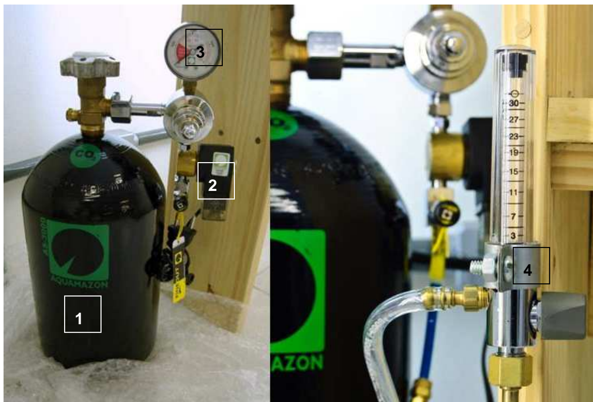
Figura 29: Cilindro de CO 2 (1), válvula solenóide (2), manômetro do cilindro (3) e fluxômetro (4) utilizados no sistema.
