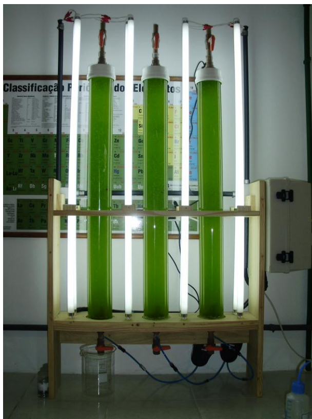
Figura 2- Fotobiorreator tubular tipo coluna de bolhas.
