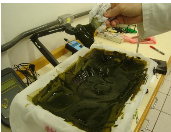
Figura 17– Biomassa de microalgas recuperada após filtragem do material eletroflotado utilizando tecido de algodão
