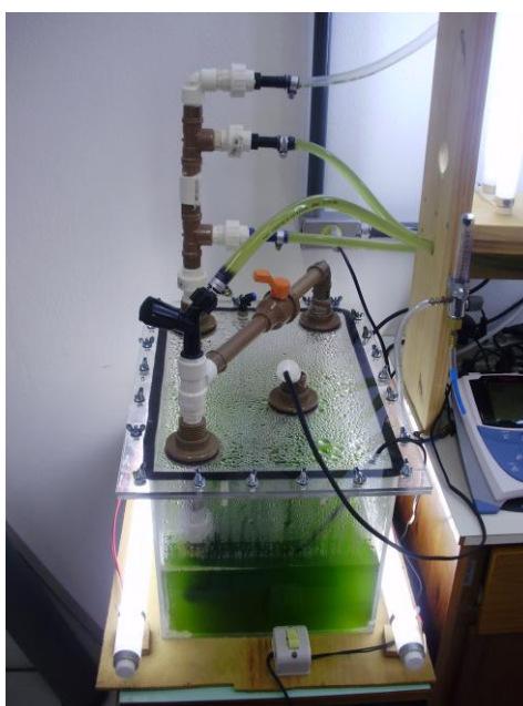
Figura 11- Reservatório após a adição de lâmpadas
