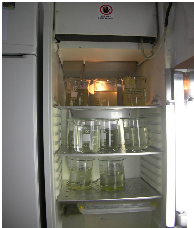
Figura 15: Incubadora modificada de DBO utilizado no cultivo de dáfneas. Fonte: Autor
