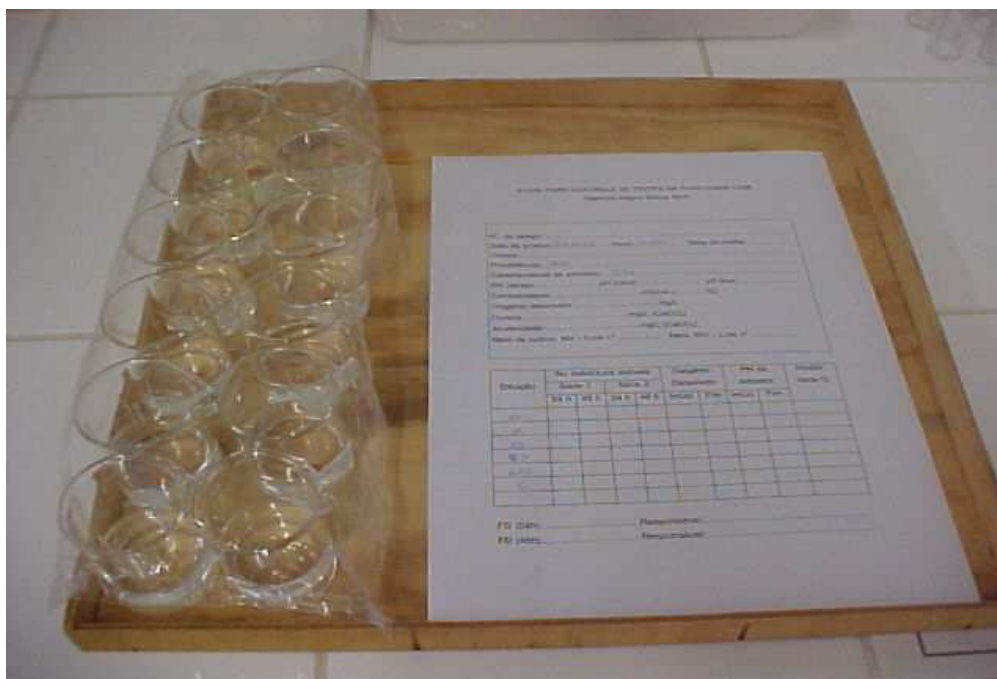
Figura 17: Realização de teste de toxicidade com Daphnia magna no laboratório de Ecotoxicologia da UNISC. Fonte: Autor
