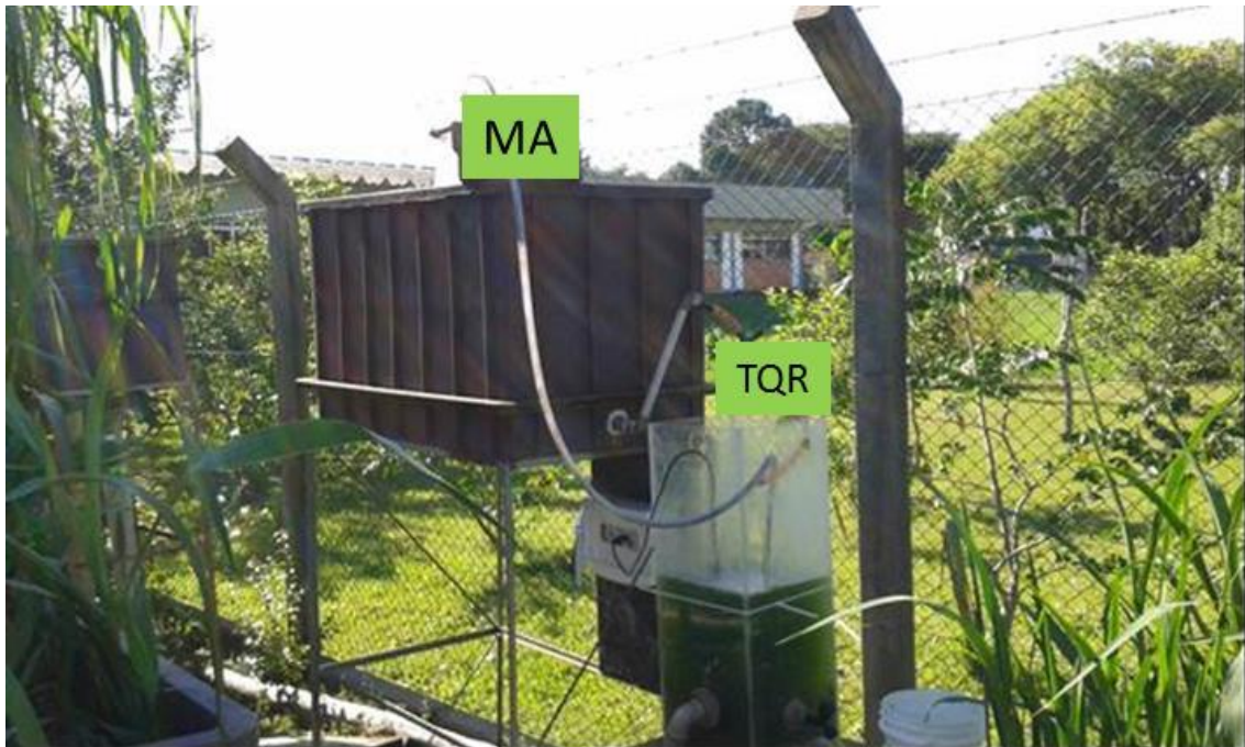
Figura 4: Configuração I: Fotobiorreator do tipo cone para proliferação das Microalgas (MA); (TQR) Tanque de Recirculação.
