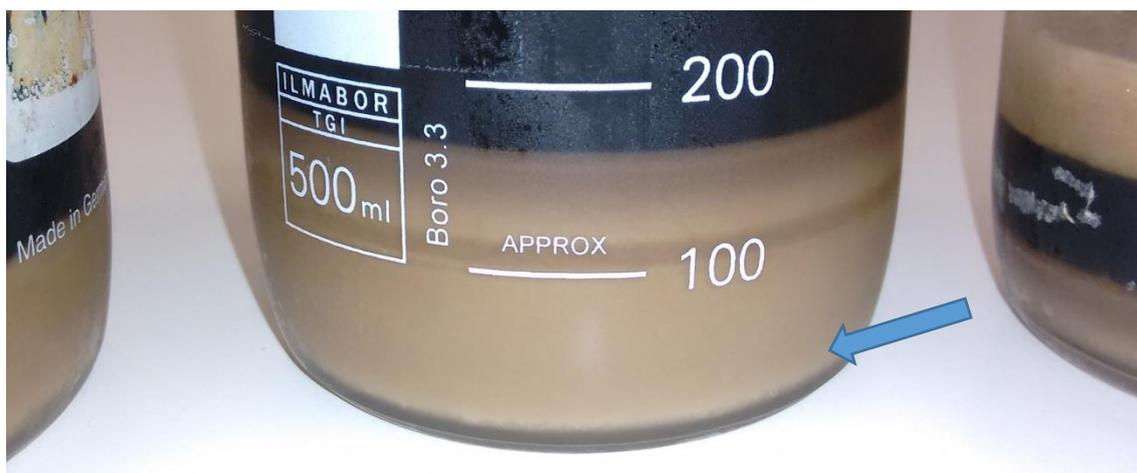
Figura 09. Hidrolisado de torta de sementes de tabaco após a neutralização com KOH, onde ocorreu a formação de sais (seta).
