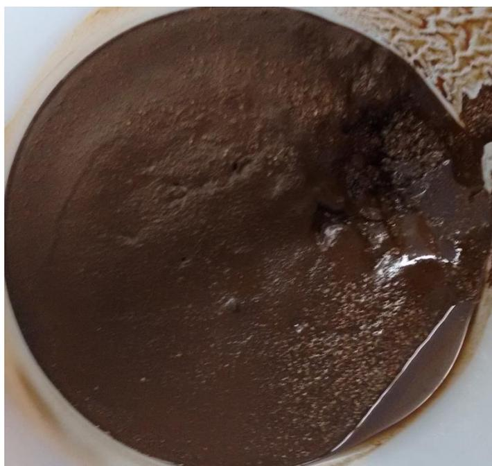
Figura 08. Registro da torta de sementes de tabaco logo após ter sido submetida a hidrólise ácida, apresentando uma alteração em seus aspectos visual (de grumos e escamas para uma espécie de borra).
