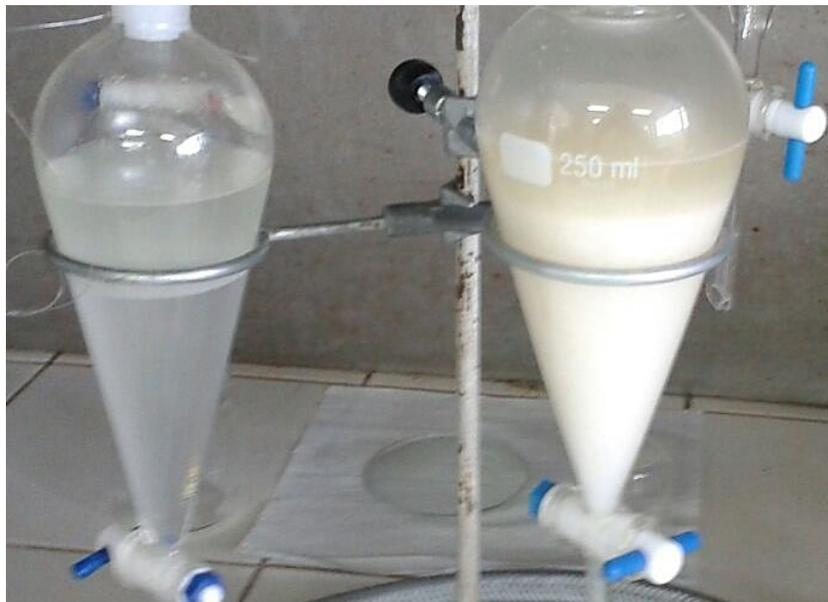
Figura 28. Extração do polímero obtido dos cultivos utilizando glicose como fonte de carbono (esquerda) e hidrolisado de torta de sementes de tabaco (direita).
