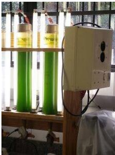
Figura 3. Fotobiorreator utilizado no cultivo de microalgas.
