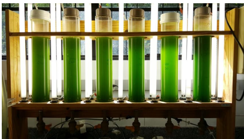
Figura 6. Experimento realizado em fotobiorreatores de 2,5 L com diferentes concentrações de glicerol.
