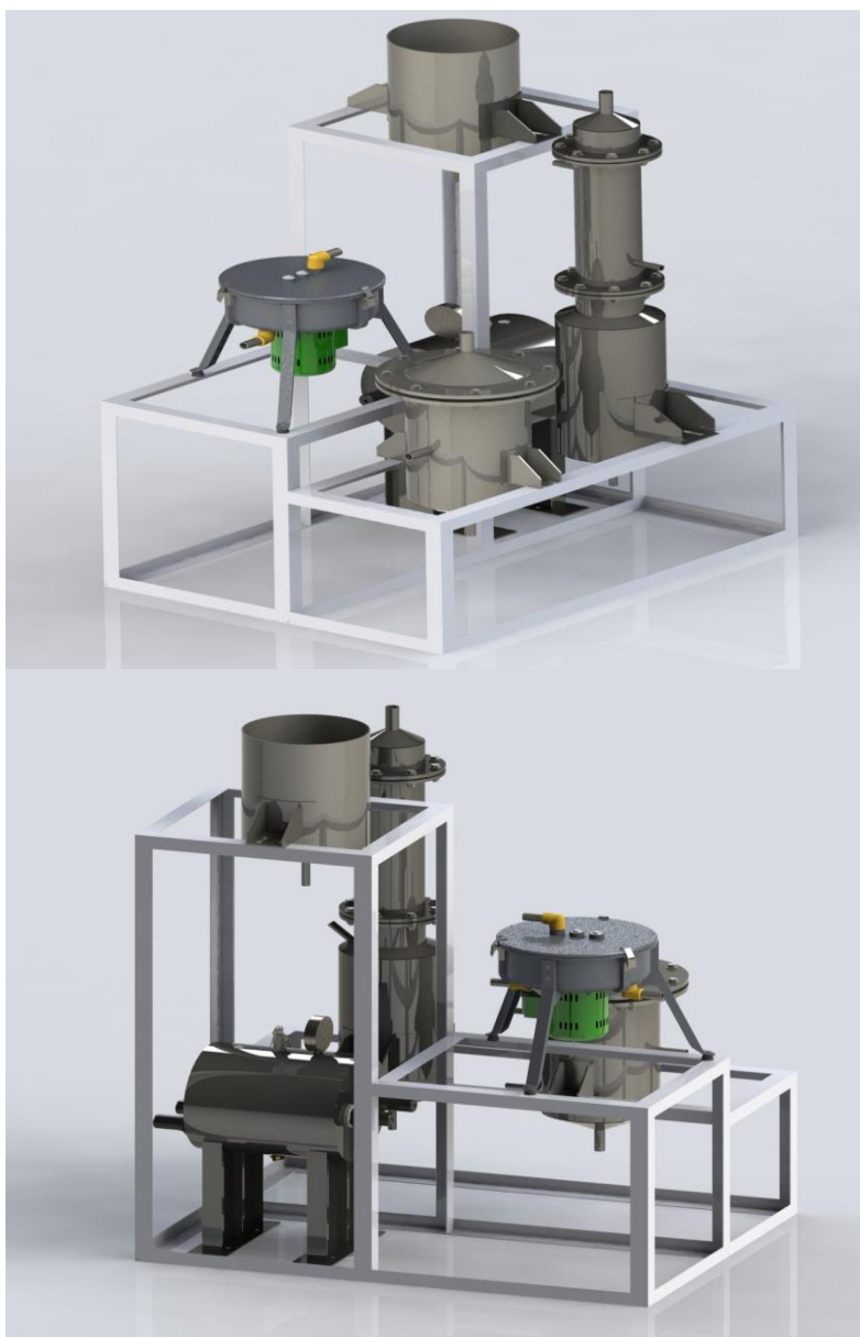
Figura 15 - Unidade de secagem e centrifugação do óleo de mamona.
