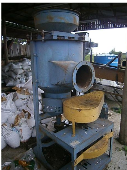
Figura 6 - Descascadora de grãos de mamona instalada na COOPERFUMOS
