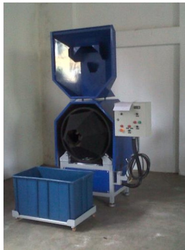
Figura 7 - Sistema de extração composto por: A) Extratora de óleos; B) Secadora e misturadora rotativa
