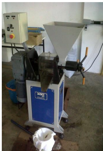
Figura 7 - Sistema de extração composto por: A) Extratora de óleos; B) Secadora e misturadora rotativa
