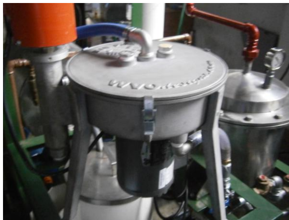
Figura 8 - Centrifuga utilizada para separação das fases.
