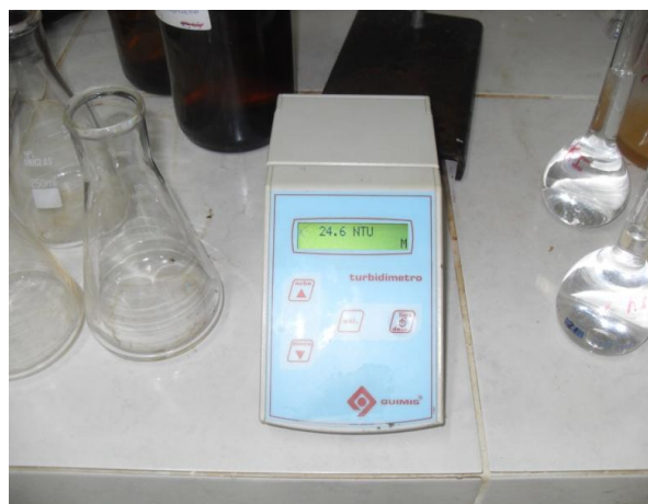
Figura 9 - Turbidímetro utilizado na análise de fosfolipídios
