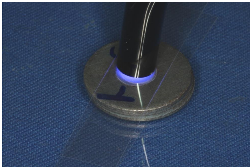
Figura 3 – Polimerização da resina
