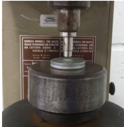
Figura 6 - Corpo de prova posicionado sob o penetrador para realização das medições
