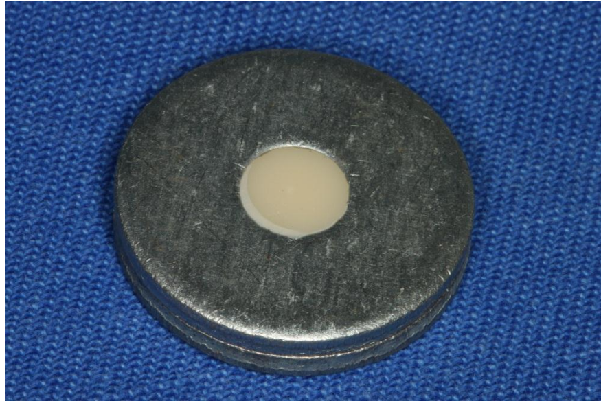
Figura 4 - Corpo de prova para a realização do teste de dureza
