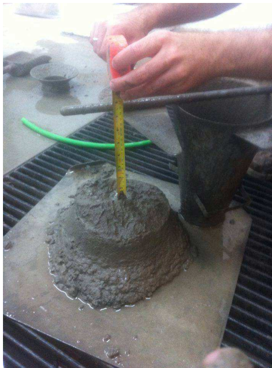
Figura 34: Execução do ensaio de abatimento
