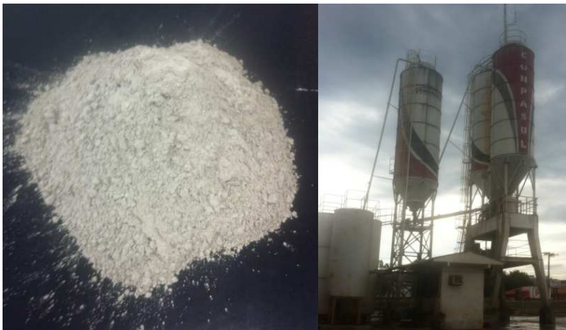
Figura 22: Cimento portland CII F-40 e silo de armazenamento
