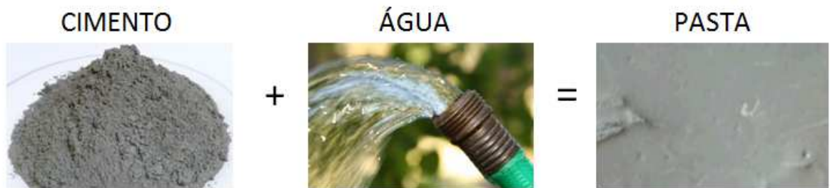
Figura 2 – Pasta de cimento
