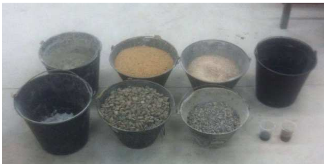
Figura 33: Materiais separados e pesados para execução do concreto
