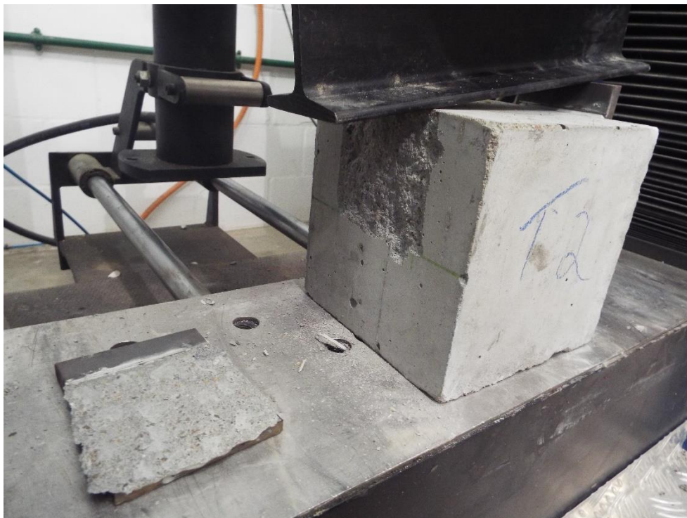
Figura 32 - Rompimento do protótipo 2 - entre aço e concreto com adesivo epóxi
