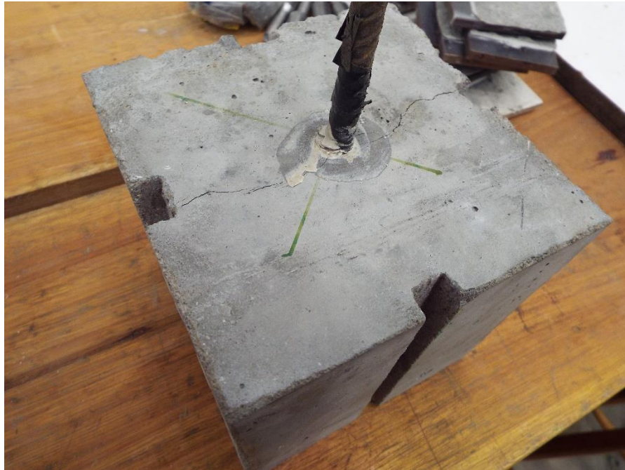
Figura 38 - Fissura no bloco
