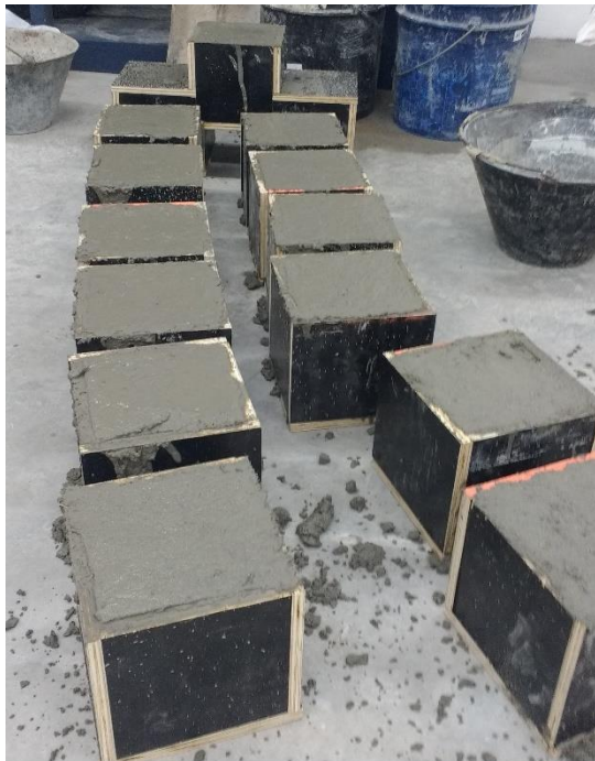
Figura 16 - Concretagem dos blocos
