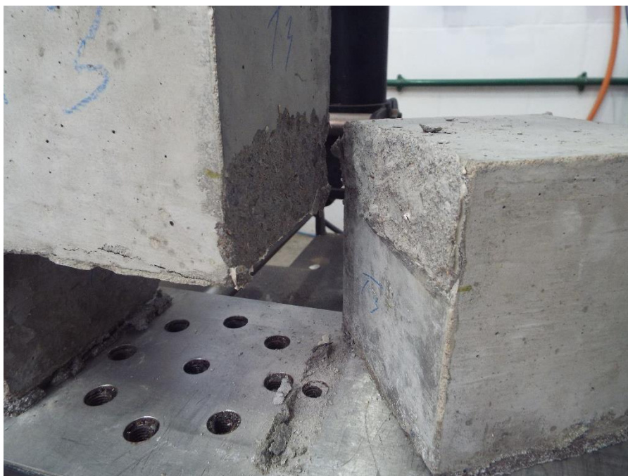
Figura 41 - Cisalhamento do concreto no Traço A
