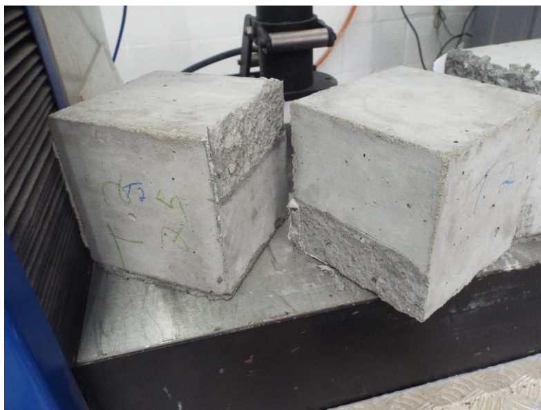
Figura 40 - Cisalhamento do concreto no Traço B
