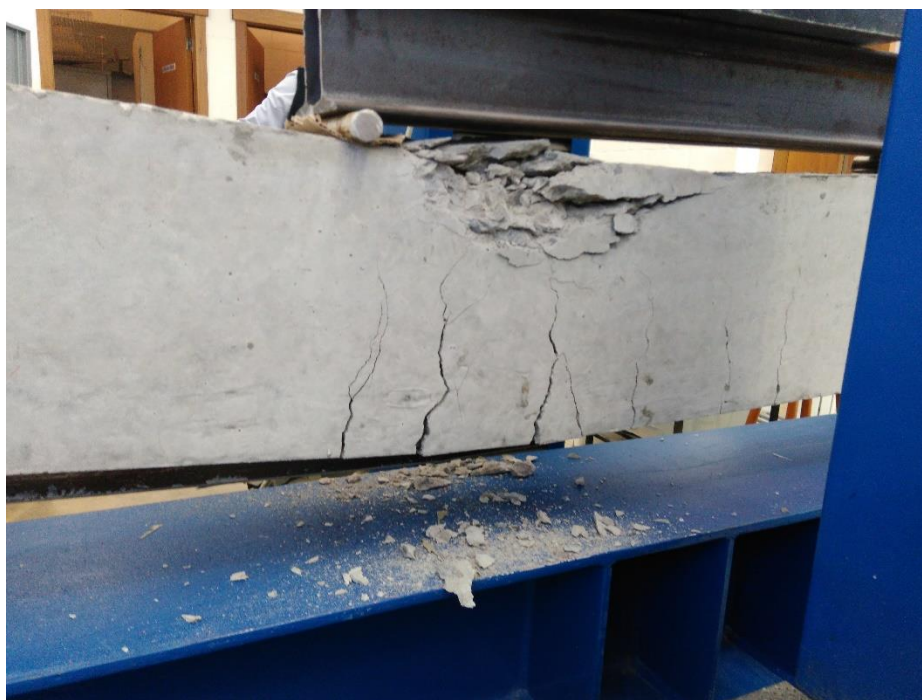
Figura 1 - Viga reforçada com chapa de aço
