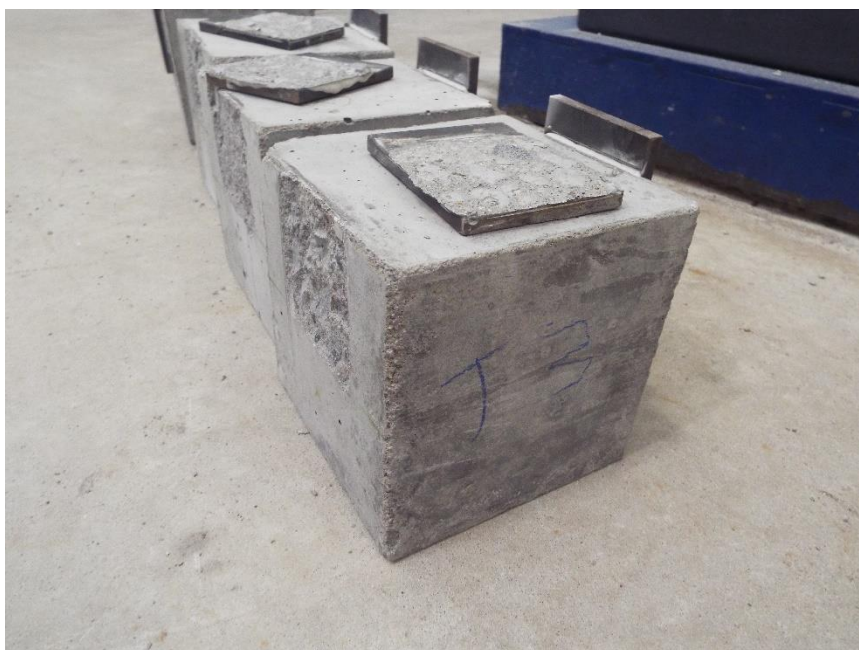
Figura 42 - Ruptura dos protótipos Aço/Concreto
