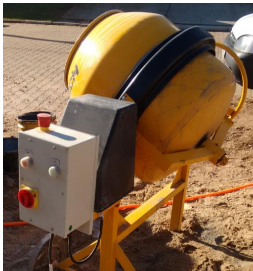
Fotografia 16 – Betoneira com proteção de partes móveis
