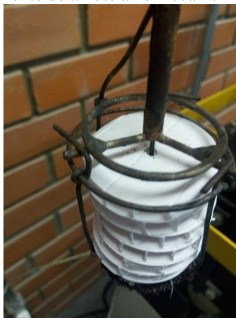
Figura 28- Posicionamento de amostra no mecanismo de inserção ao forno.
