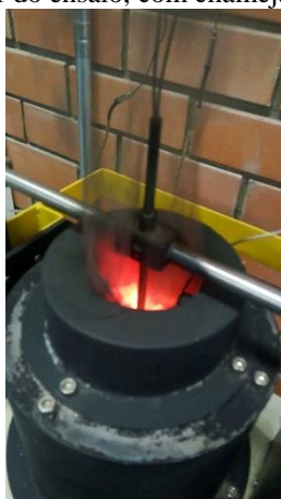
Figura 30- Decorrer do ensaio, com chamejamento mais intenso
