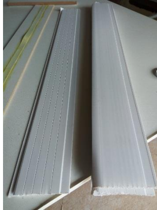
Figura 8- Forro de P.V.C. utilizado para o ensaio.
