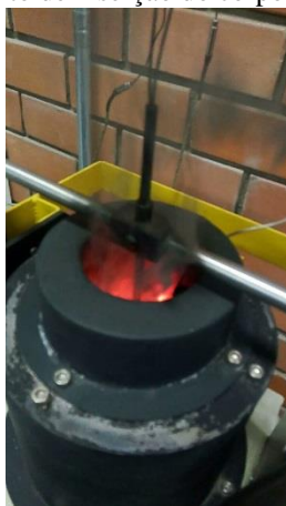
Figura 29- Momento de inserção do corpo de prova no forno.
