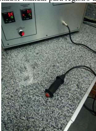
Figura 18 - Acionador manual para registro de chamejamento.
