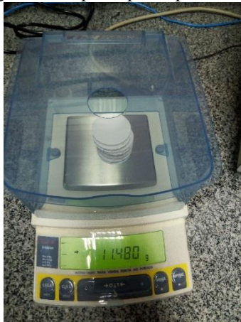
Figura 27 - Pesagem do corpo de prova para inserção do termopar.
