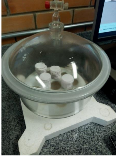
Figura 16- Amostras condicionadas no dessecador.
