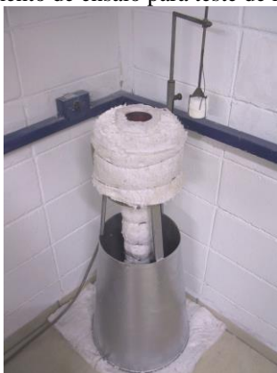
Figura 4- Equipamento de ensaio para teste de incombustibilidade.
