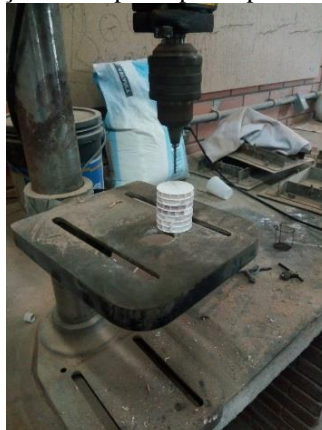
Figura 26- Perfuração do corpo de prova para inserção do termopar.
