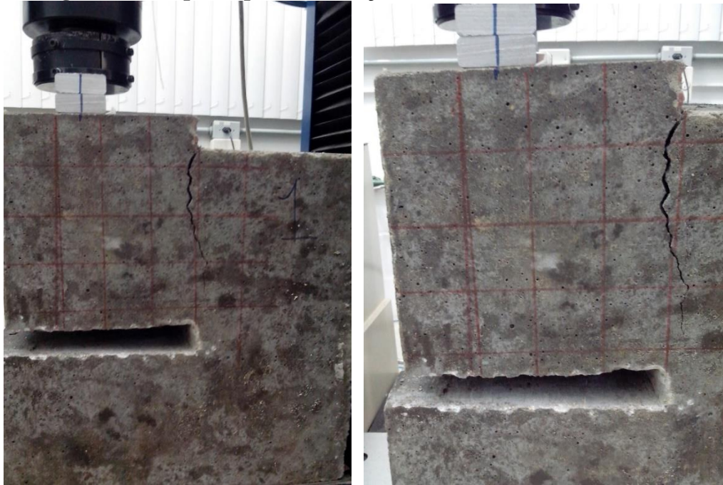
Figura 39 - Ruptura por deformação excessiva do tirante console 2
