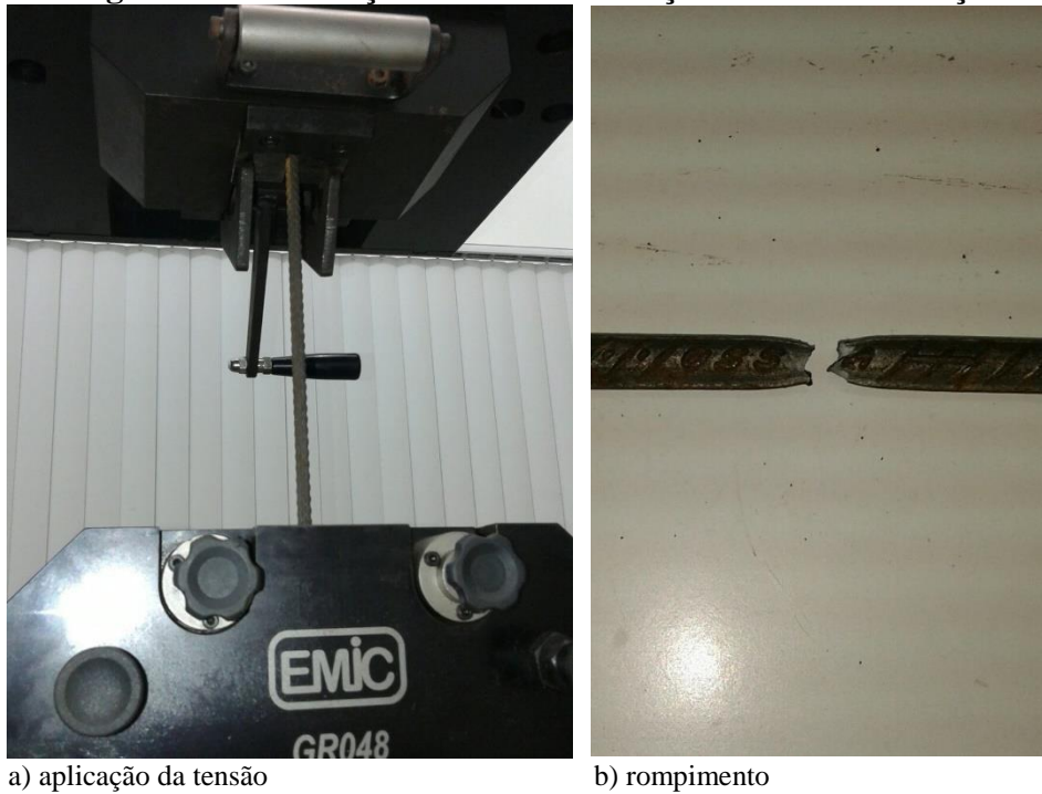
Figura 37 - Realização do ensaio de tração nas barras de aço
