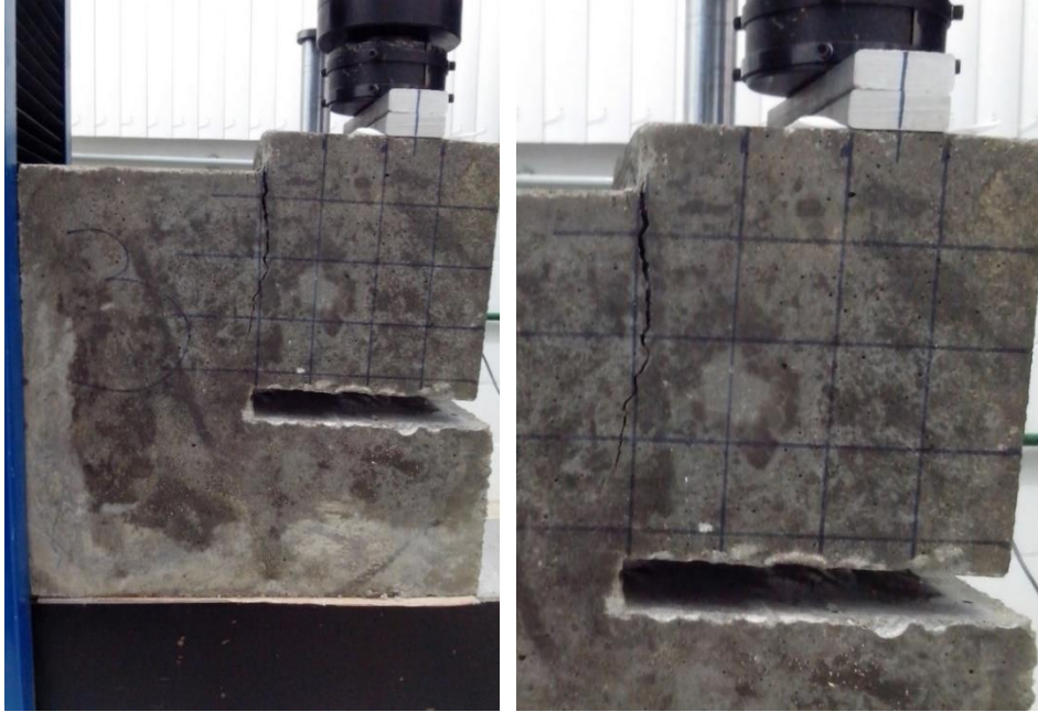
Figura 41 - Ruptura por deformação excessiva do tirante console 4
