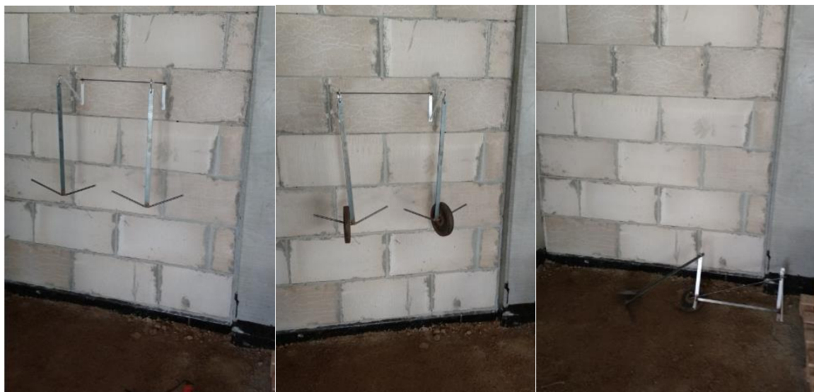
Figura 29 – Sequencia do ensaio de peças suspensas
