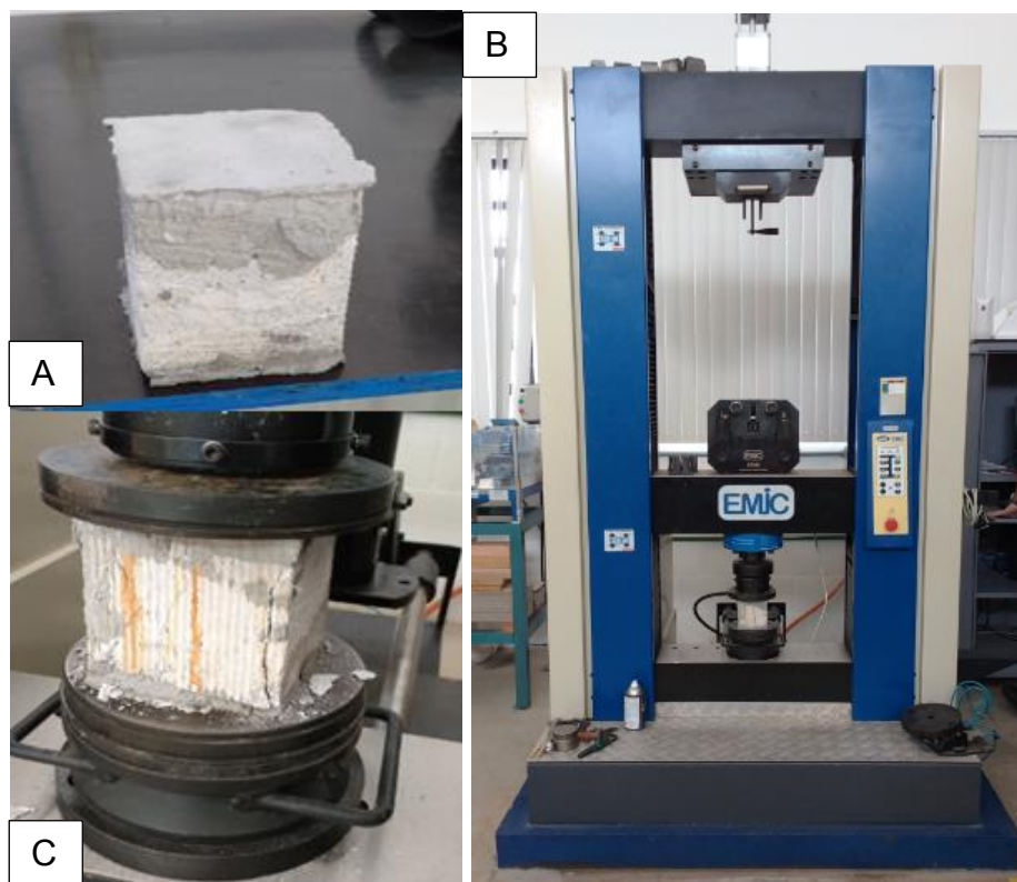
Figura 27 - Ensaio de resistência à compressão
