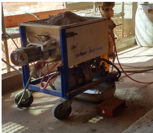
Figura 44 - Máquina de projeção de reboco
