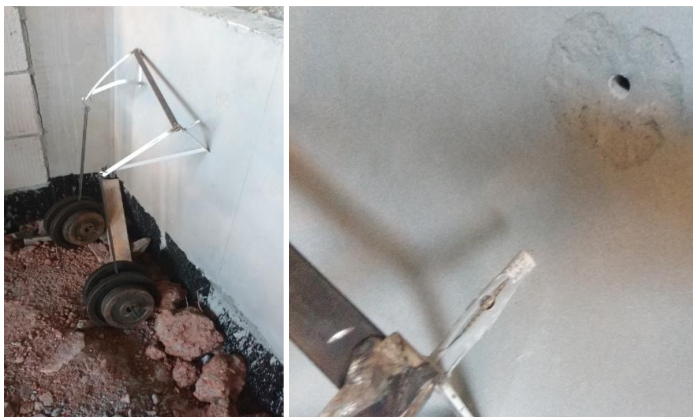
Figura 31 - Ensaio de mão francesa após rompimento
