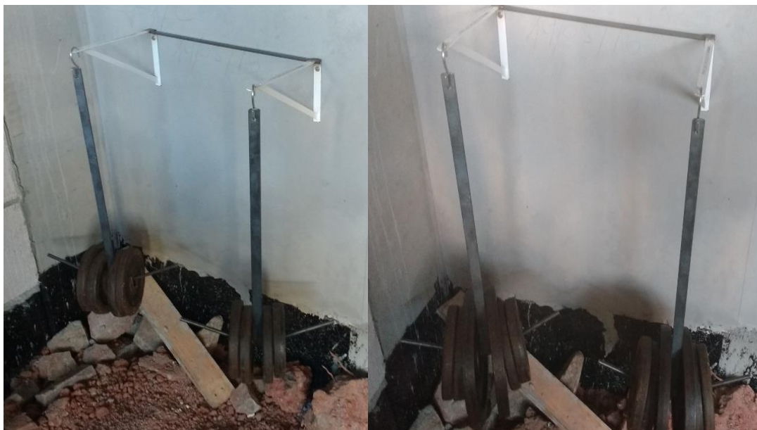
Figura 30 - Ensaio de peças suspensas com 800 N
