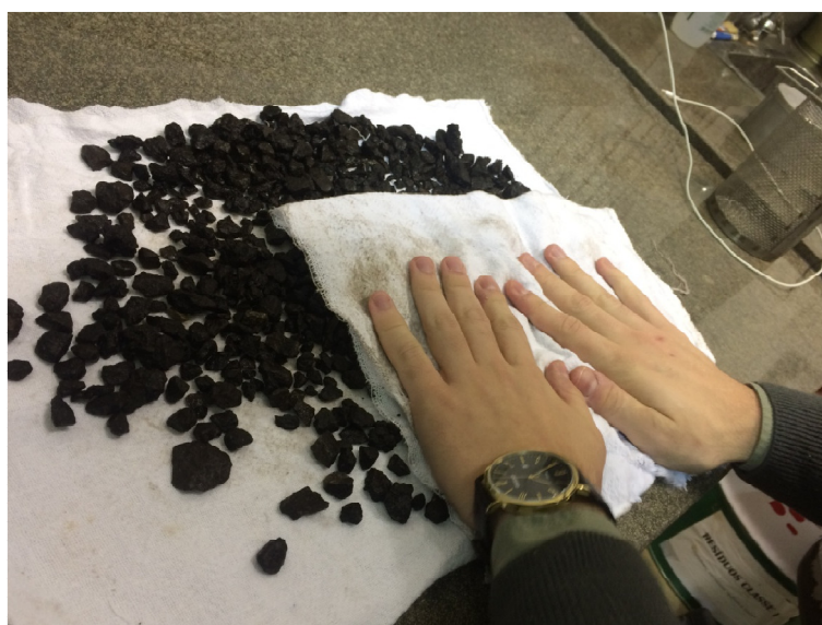
Figura 24 - Agregado sendo seco para sua condição de superfície seca
