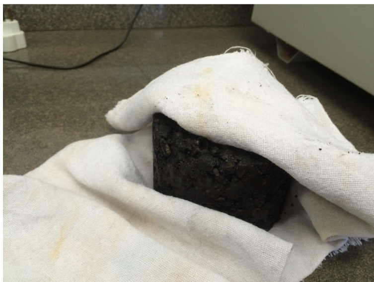
Figura 22 - CP sendo seco para sua condição de superfície seca
