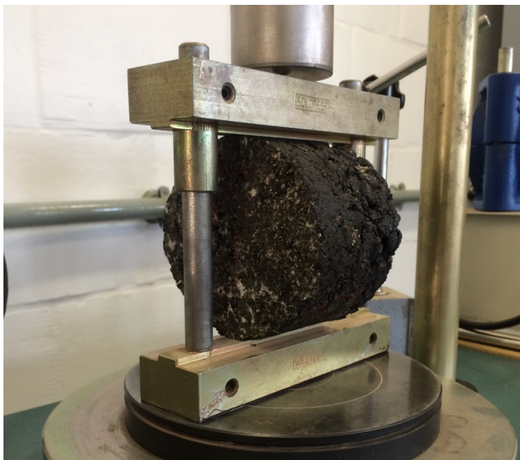
Figura 26 - Ensaio de resistência à tração por compressão diametral
