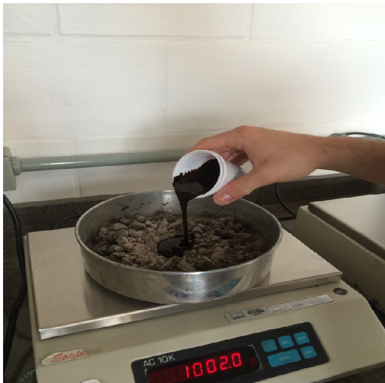
Figura 19 - Adição da emulsão asfáltica na mistura
