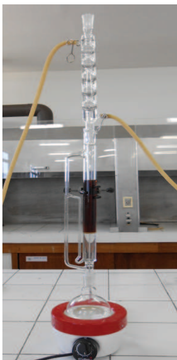
Figura 9 — Extração líquido-líquido utilizando extrator Mariner e solvente clorofórmio
