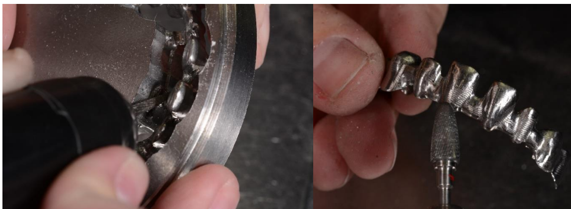
Figura 47: Acabamento e polimento na estrutura metálica
