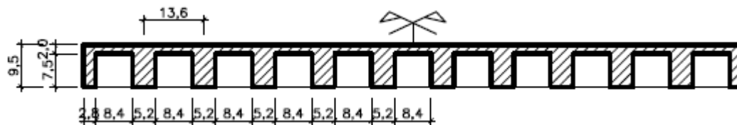
Figura 46 – Seção transversal em centímetros da geometria da laje S1
