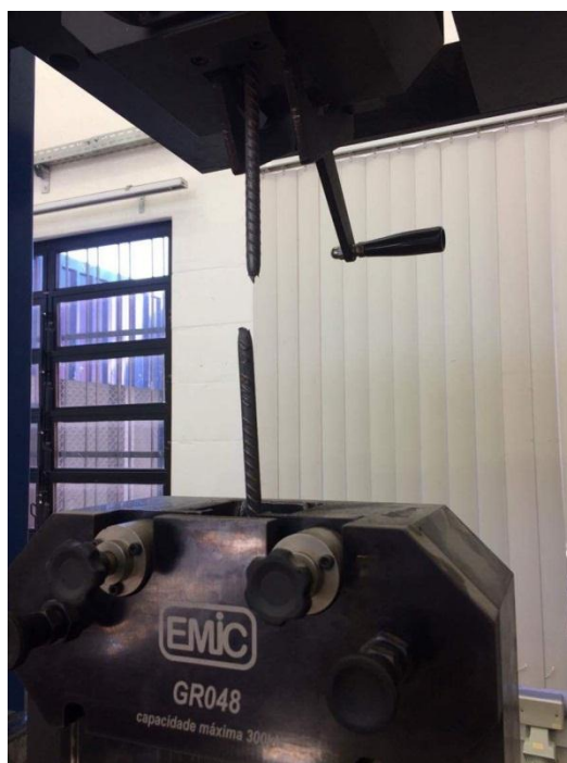
Figura 28 – Aço rompido após o ensaio de tração.
