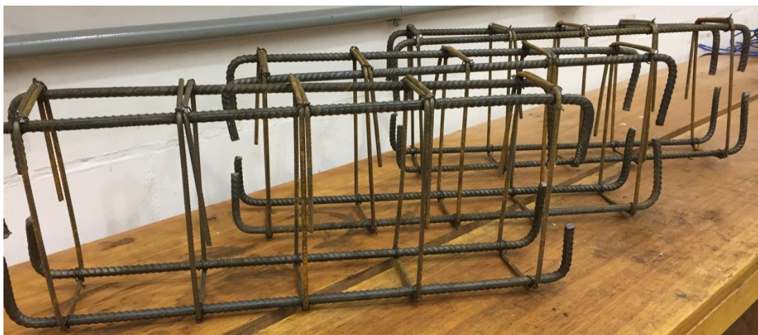
Figura 24 – Armadura da viga de apoio central.
