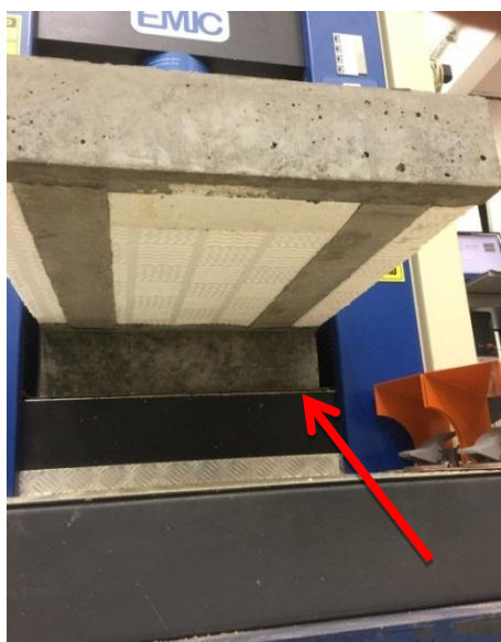
Figura 31 – Posicionamento da viga central na máquina.
