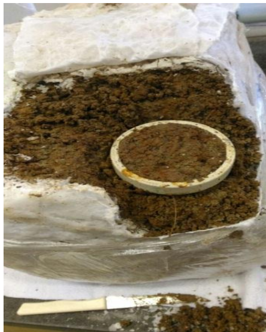
Figura 29- Retirada da amostra do bloco indeformado para o ensaio de cisalhamento direto
