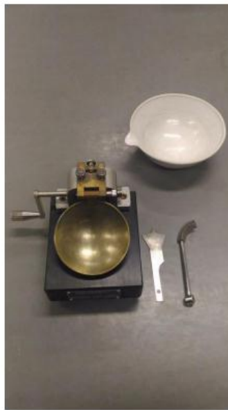
Figura 26 – Material para realização do ensaio de Limite de Liquidez (LL)
