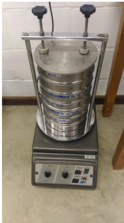
Figura 25 - Etapa de peneiramento com o auxílio do agitador mecânico
