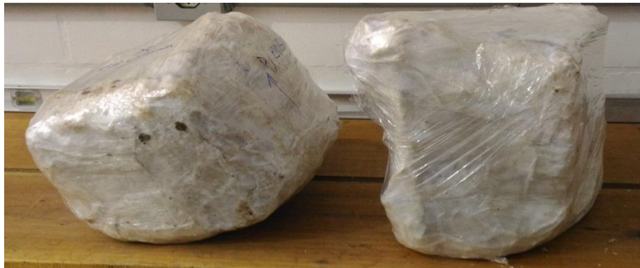
Figura 23 - Blocos após aplicação de parafina e tecido, envolto com plástico filme
