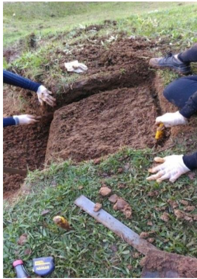
Figura 20 - Preparação do local para coleta do bloco
