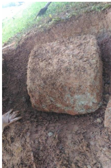
Figura 21 - Bloco pronto após escavação
