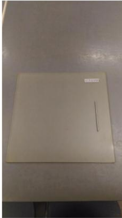
Figura 27 - Material para realização do ensaio de Limite de Plasticidade (LP)
