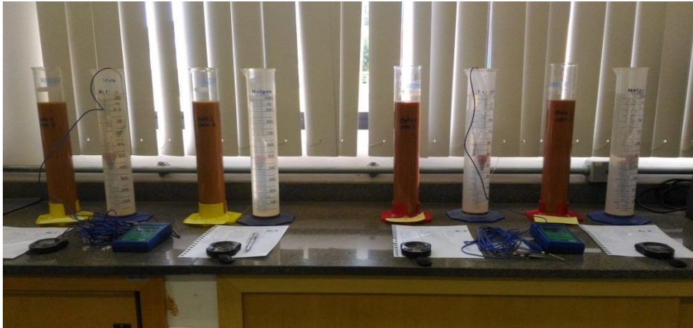
Figura 24 - Etapa de granulometria através da sedimentação
