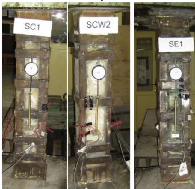
Figura 23 – Pilares reforçados com perfis metálicos para os ensaios de falha à compressão
