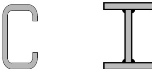
Figura 21 – Perfis obtidos por processos metalúrgicos
