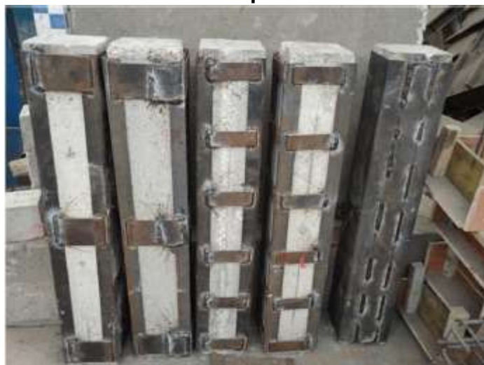
Figura 24 – Configuração dos reforços de pilares para ensaios de falha à compressão
