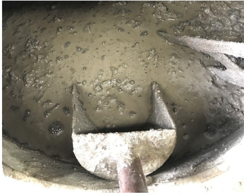
Figura 6 - Reação do cimento com o aditivo Techniflow 570
