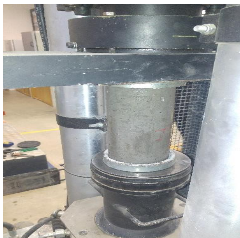
Figura 8 - Ensaio à compressão do concreto
