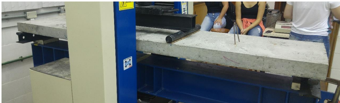
Figura 19 - Laje posicionada para ensaio
