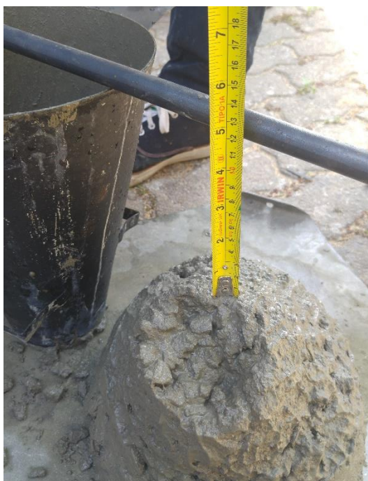
Figura 14 - Teste de abatimento de cone
