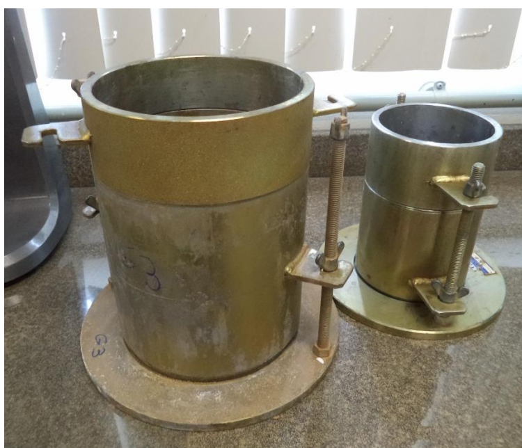
Figura 13 – Cilindros utilizados nos ensaios de compactação
