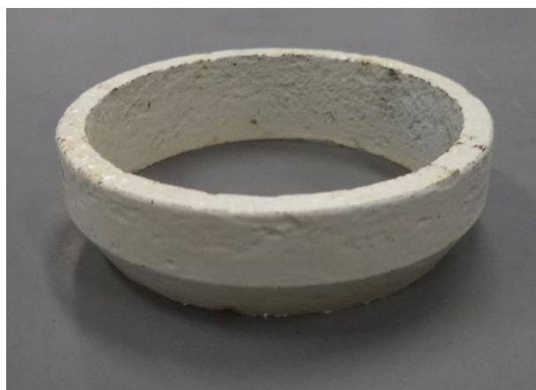
Figura 21 – Molde dos corpos de prova submetidos ao cisalhamento direto
