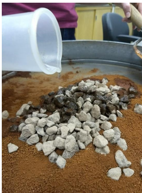
Figura 22 – Solo-brita sendo preparado para o ensaio de compressão simples
