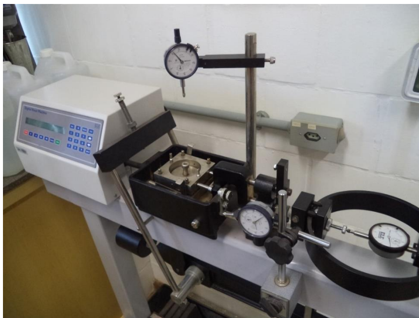
Figura 19 - Conjunto do equipamento constituído de caixa de cisalhamento, anel dinamométrico para aplicação de carga e extensômetros
