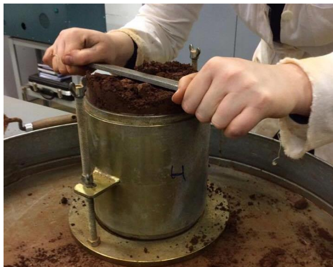
Figura 14 – Rasamento do excesso de material compactado
