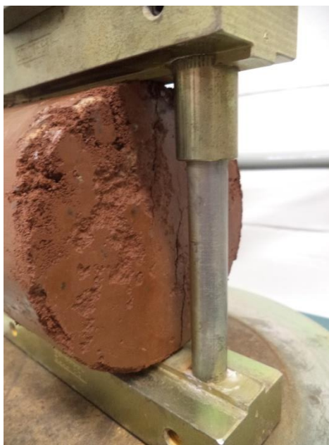
Figura 26 – Corpo de prova após ruptura disposto no Pórtico de Lottman
