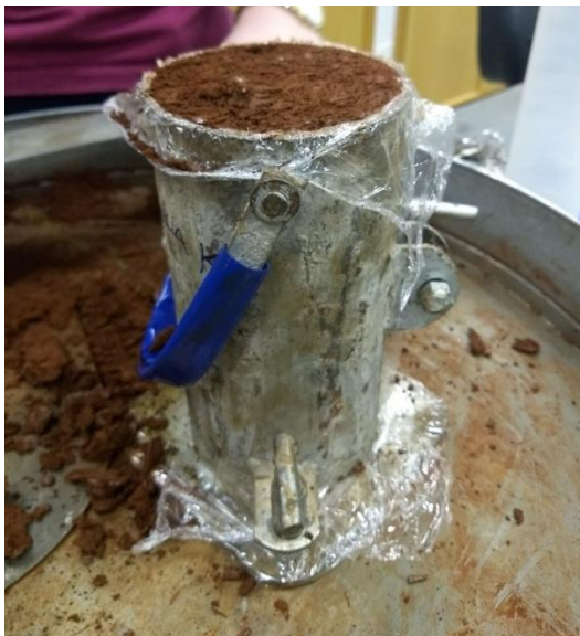
Figura 23 – Molde cilíndrico utilizado no ensaio de compressão simples
