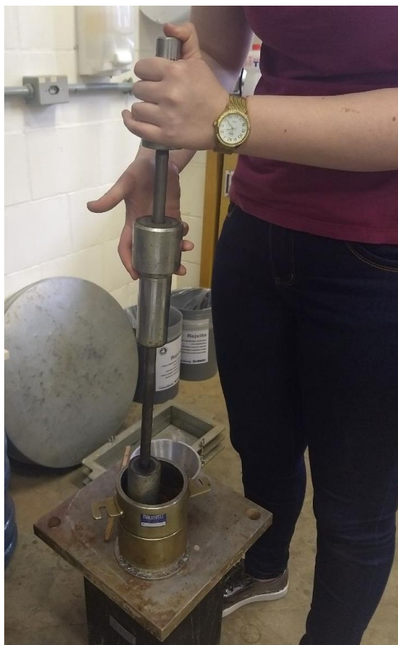
Figura 25 – Moldagem do corpo de prova submetido ao ensaio de compressão diametral
