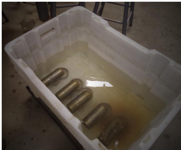
Figura 17 – Corpos de prova no recipiente de imersão
