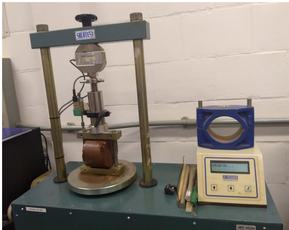
Figura 28 – Prensa utilizada no ensaio de compressão diametral
