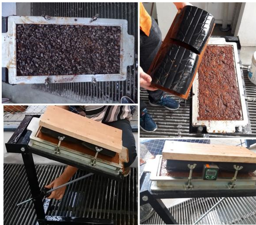
Figura 29 – Equipamento desenvolvido para a determinação do coeficiente de atrito
