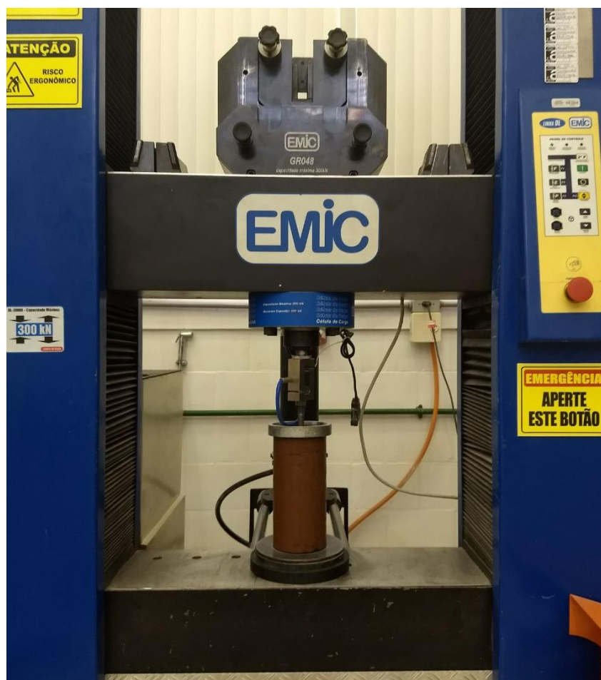
Figura 24 – Realização do ensaio de compressão simples
