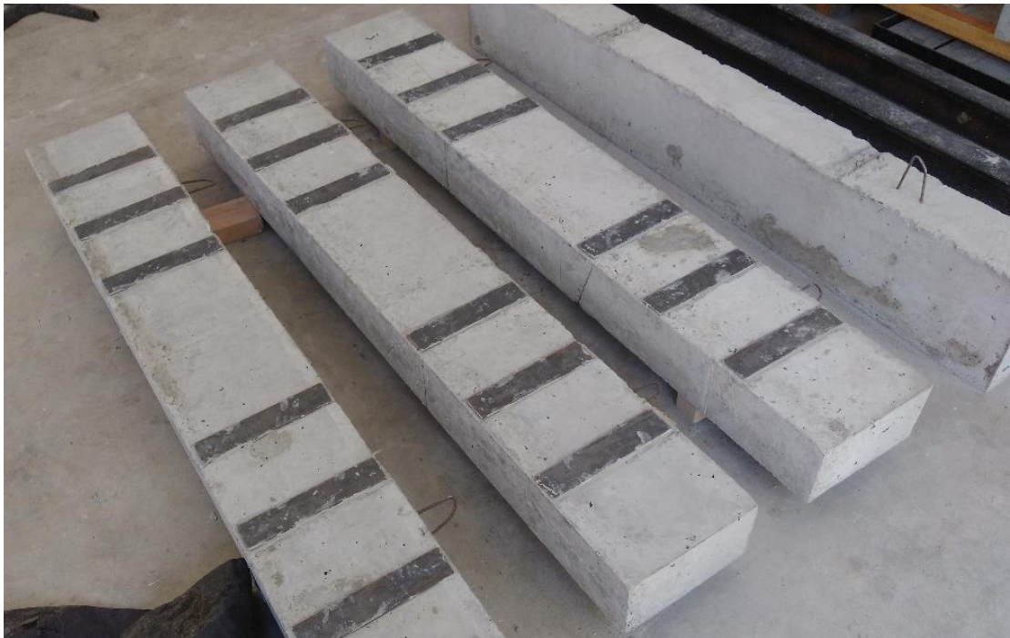
Figura 51 - Protótipos devidamente reforçados
