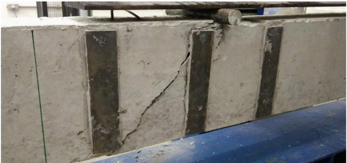
Figura 59 - Ruptura dos protótipos reforçados (Teste 04)
