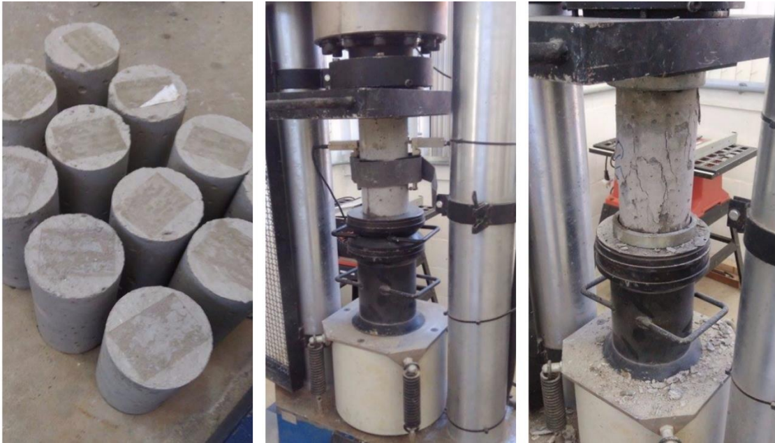
Figura 33 - Ensaio de compressão dos CPs de concreto
