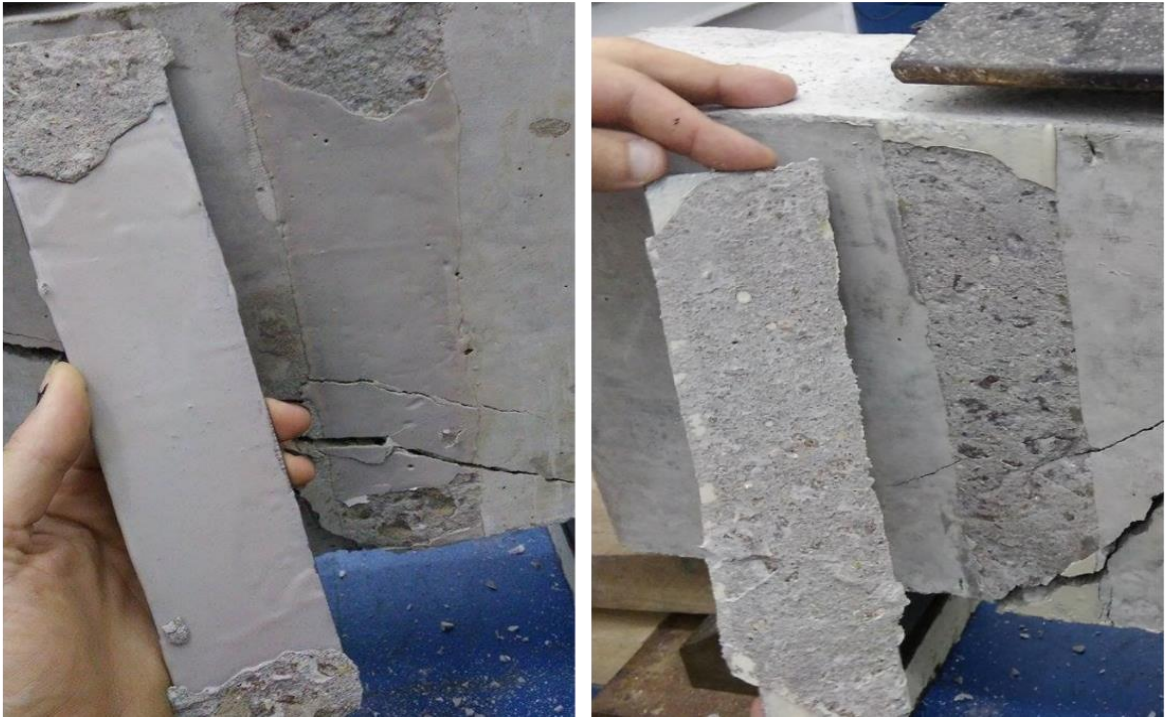
Figura 58 - Detalhamento deslocamento do reforço
