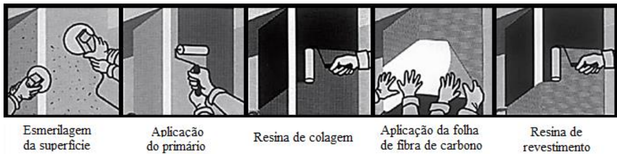
Figura 23 - Procedimento de aplicação do reforço com fibras de carbono
