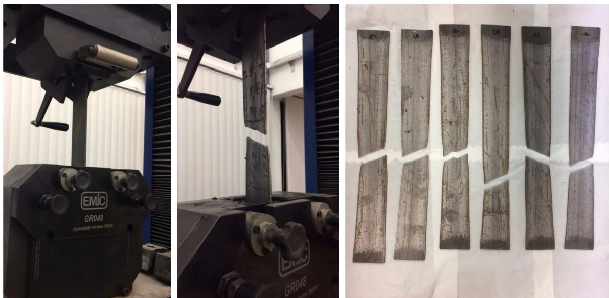
Figura 36 - Ensaio de tração nas chapas metálicas de reforço
