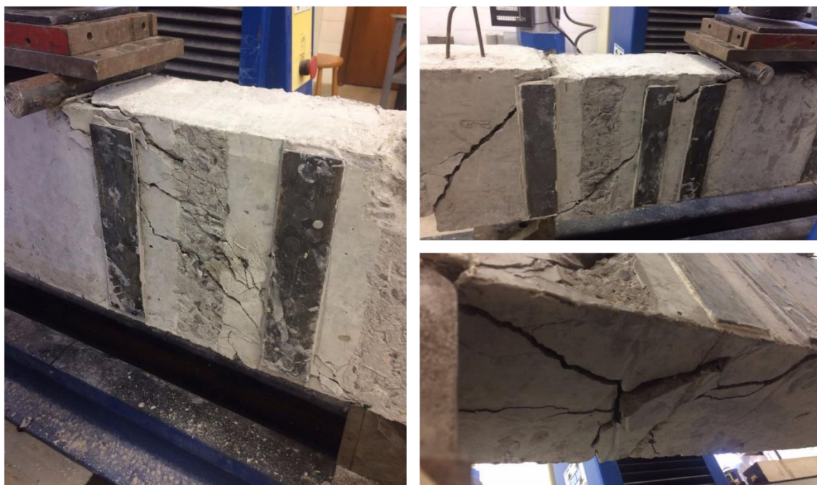
Figura 64 - Rupturas do ensaio complementar (Teste 06)
