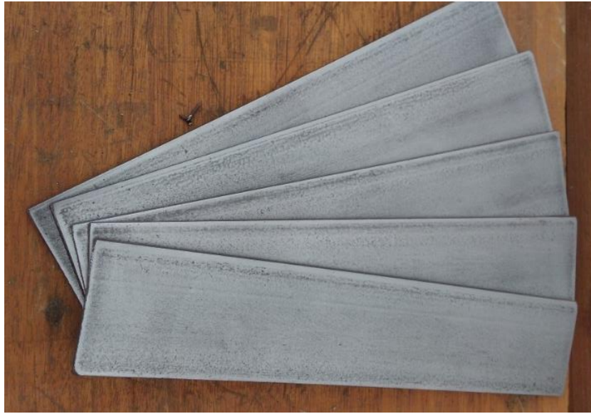
Figura 35 - Chapas metálicas 1/8"x2" pós corte
