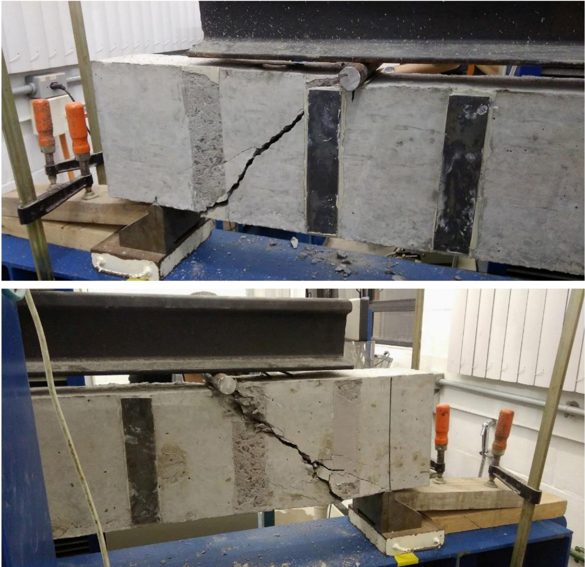
Figura 57 - Ruptura dos protótipos reforçados (Teste 03)
