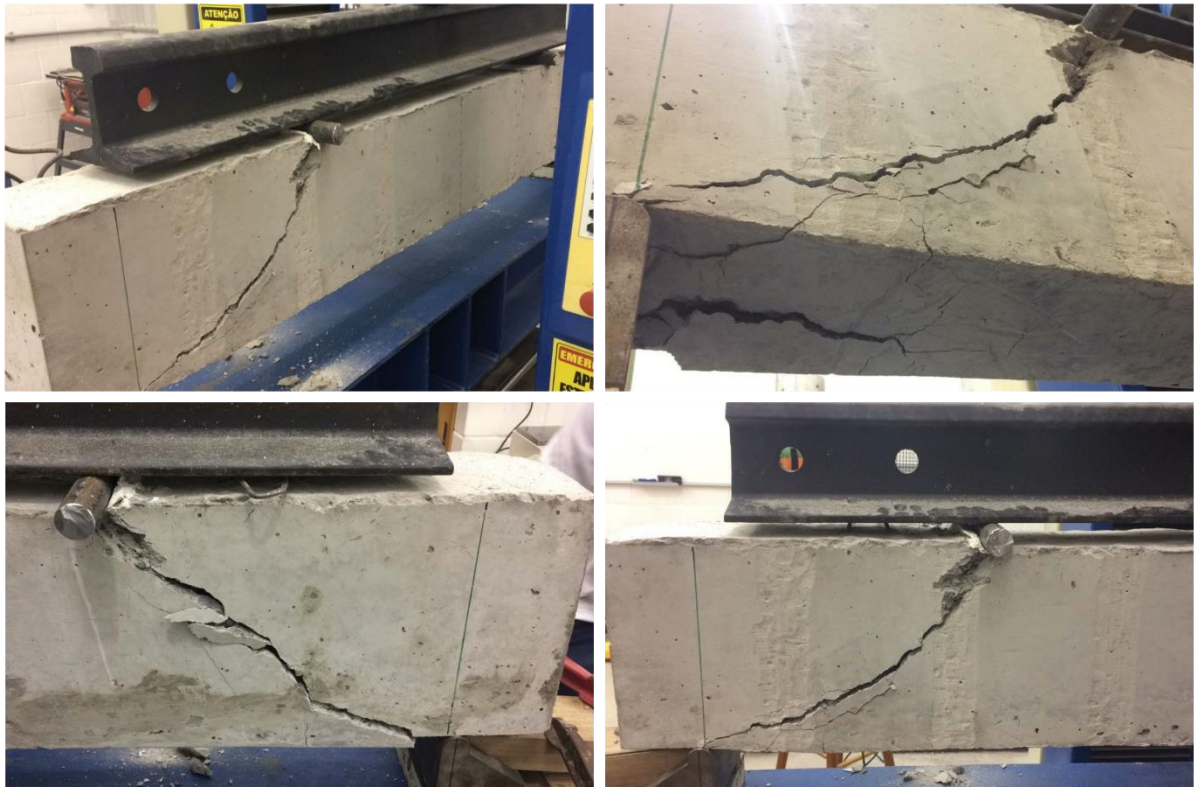
Figura 56 - Ruptura dos testemunhos (Testes 01 e 02)
