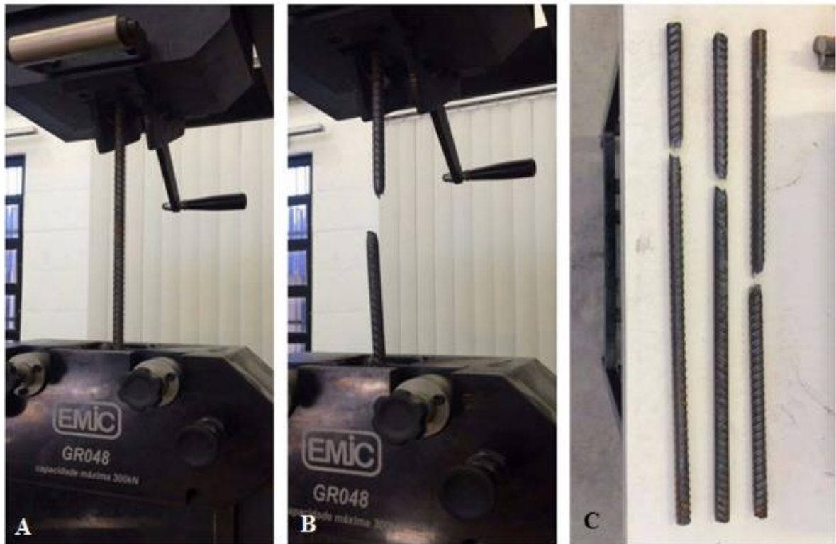
Figura 31 – Ensaio de tração nas barras de aço
