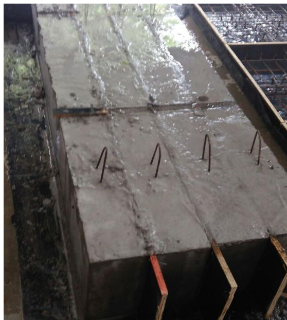
Figura 46 - Protótipos desformados e em cura úmida
