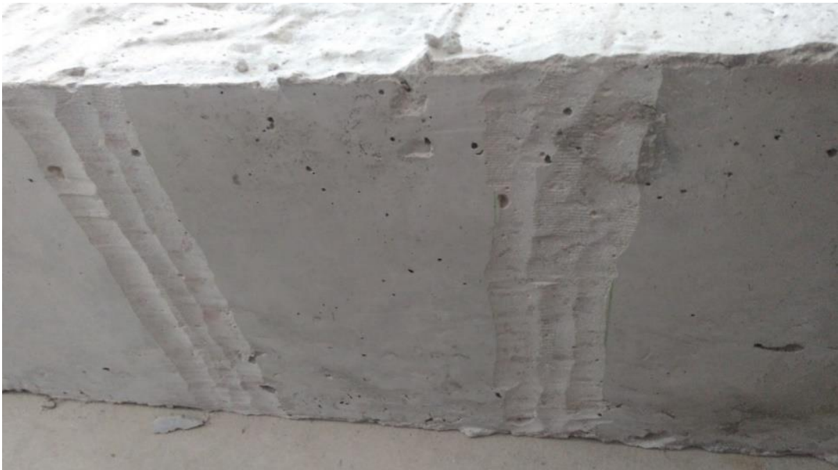
Figura 48 - Preparação da superfície dos protótipos
