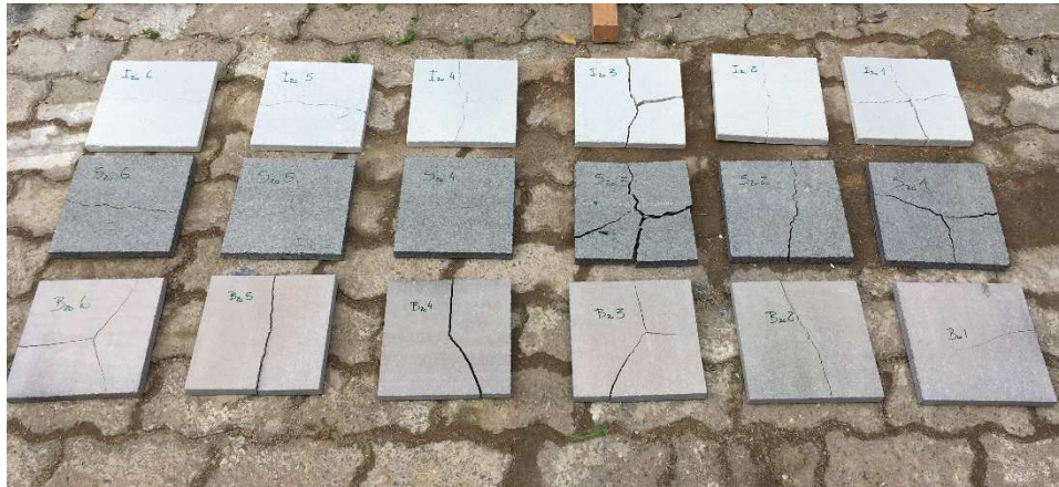
Figura 33 – Amostras rompidas: Itaúna, Preto São Gabriel e basalto, respectivamente
