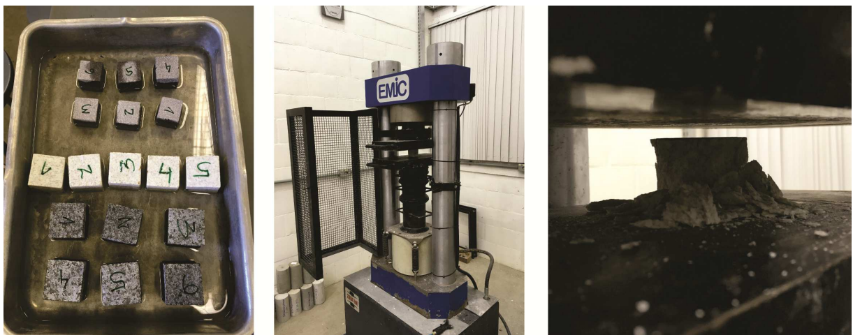
Figura 20 – Processos do ensaio de compressão uniaxial: amostras em processo de submersão, acomodação do corpo de prova na prensa e detalhe de peça rompida, respectivamente
