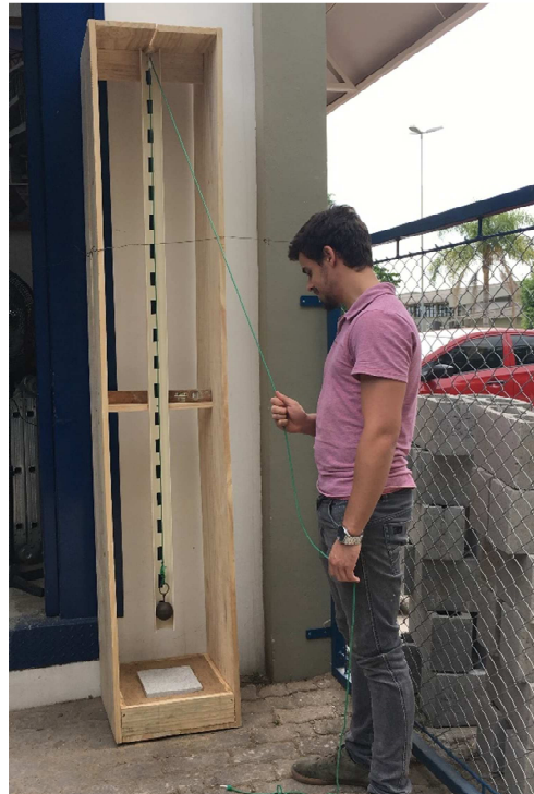
Figura 31 – Aparelho desenvolvido para ensaio de impacto de corpo duro
