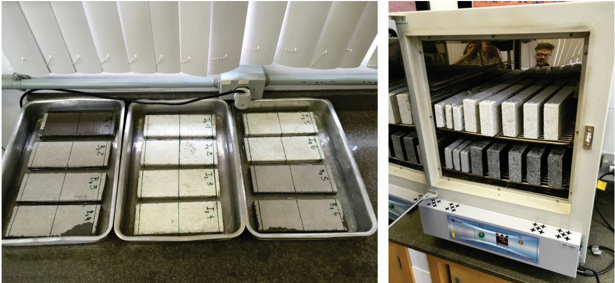
Figura 22 – Saturação e secagem dos corpos de prova para ensaio de flexão por 3 pontos
