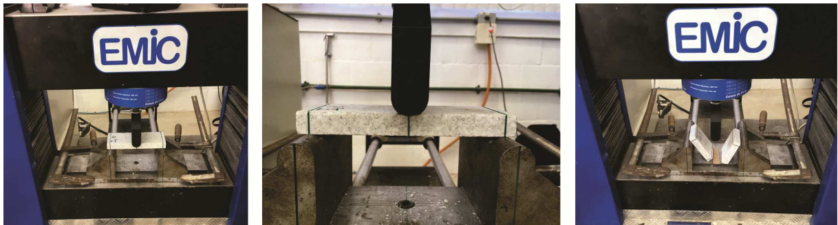
Figura 24 – Posicionamento utilizado para ensaio de flexão por 3 pontos
