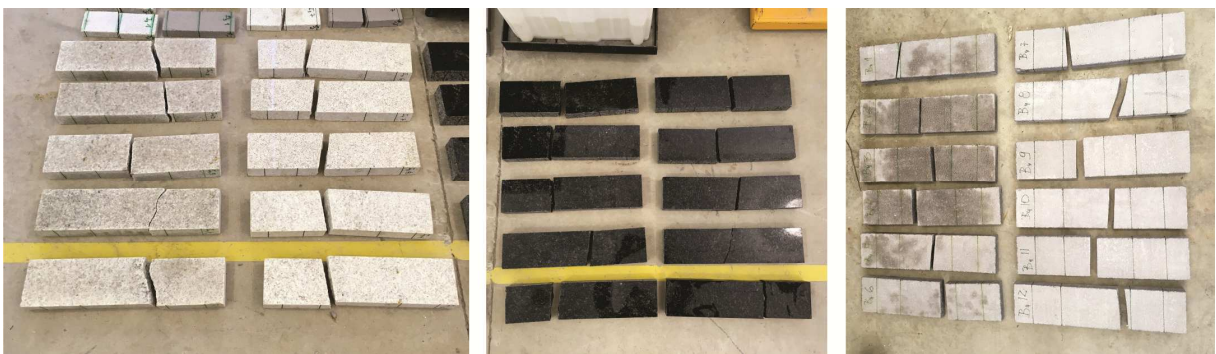
Figura 28 – Amostras rompidas: Itaúna, Preto São Gabriel e basalto, respectivamente
