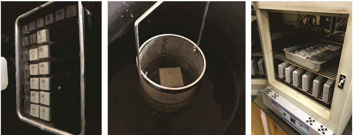
Figura 19 – Processos do ensaio de absorção: corpos de prova submersos, pesagem hidrostática e secagem no forno, respectivamente
