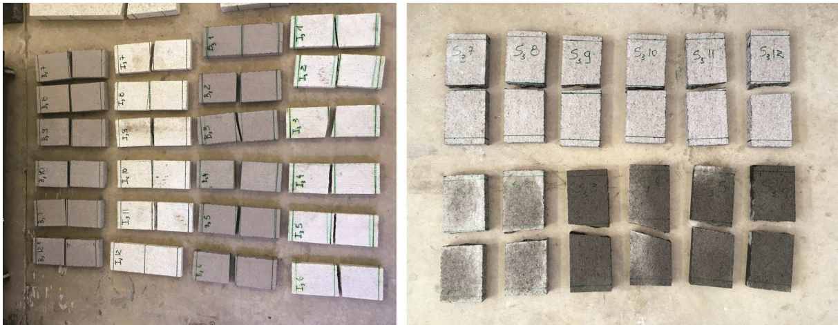
Figura 25 – Amostras rompidas: basalto e Itaúna, e respectivamente Preto São Gabriel
