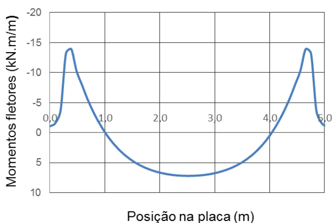
Figura 73 – Diagrama de momentos fletores nas paredes 3 e 4 – Eixo horizontal
