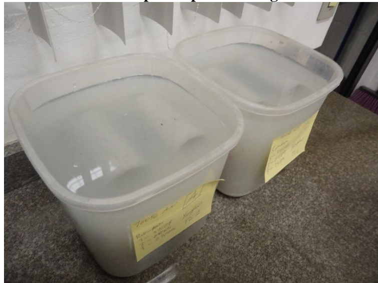
Figura 23 – Cura dos corpos de prova de argamassa em imersão.
