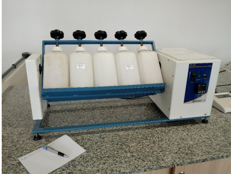
Figura 18 – Equipamento de agitação para obtenção do extrato lixiviado.
