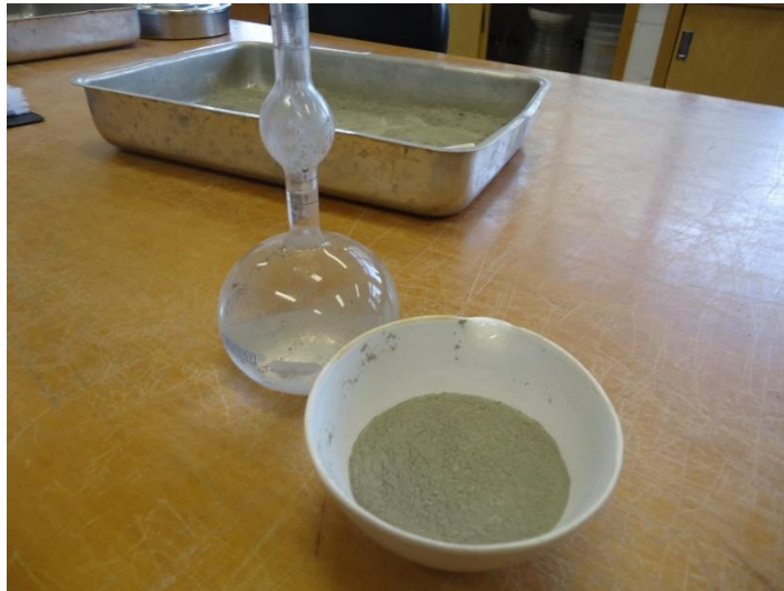
Figura 11 – Amostra de cimento a ser ensaiada no frasco de Le Chatelier.
