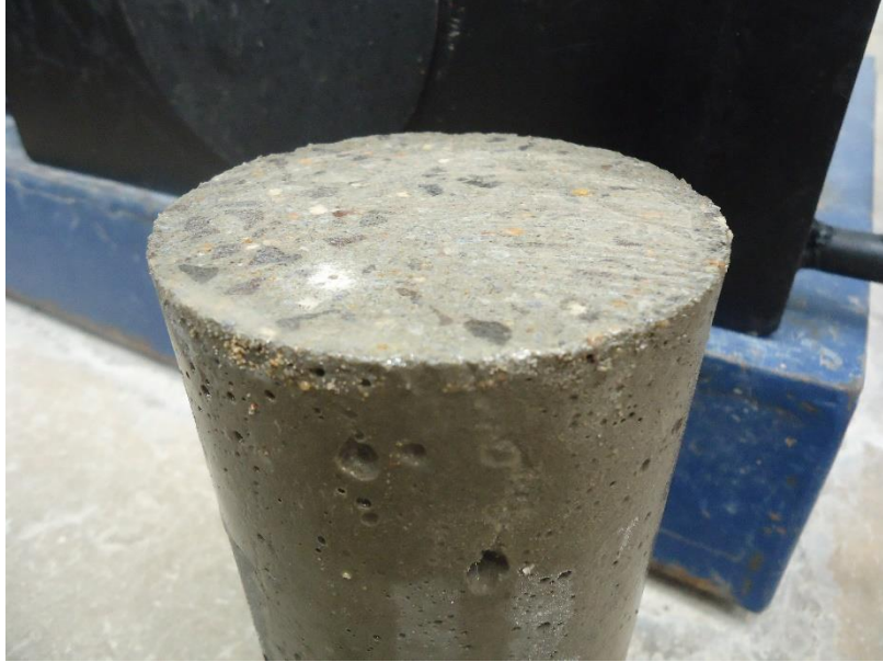
Figura 16 – Corpo de prova retificado pronto a ser ensaiado a compressão axial.
