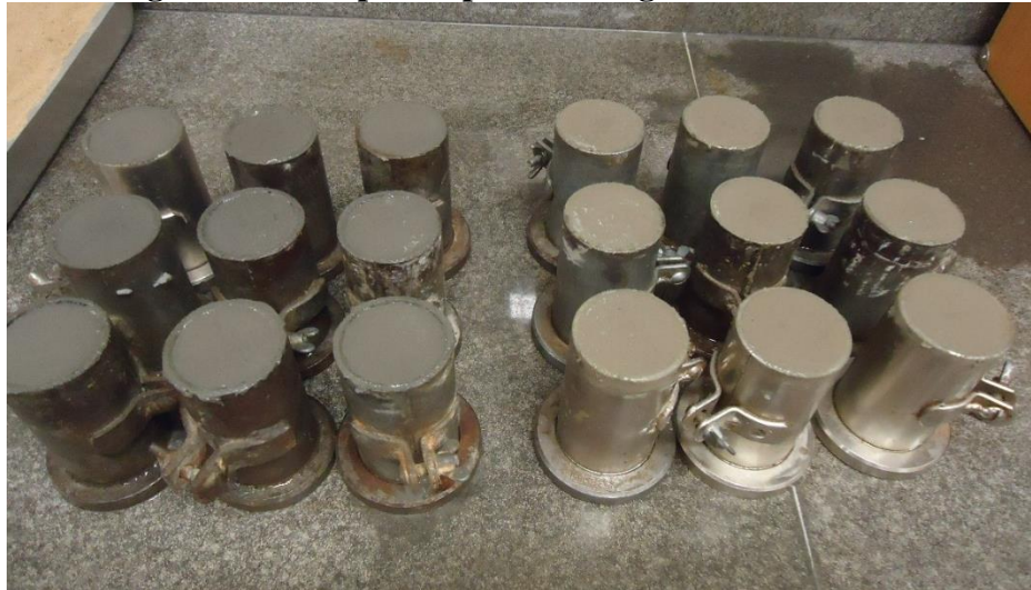
Figura 22 – Corpos de prova de argamassa moldados.
