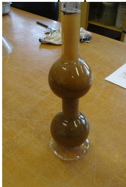
Figura 9 – Areia natural no frasco de Chapman para determinação da massa específica.
