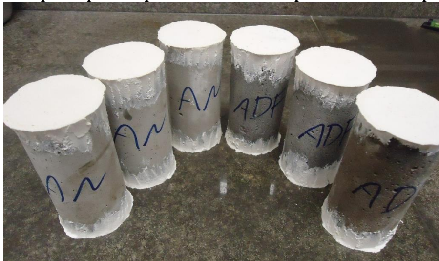
Figura 24 – Corpos de prova capeados e identificados para ensaio de compressão axial.
