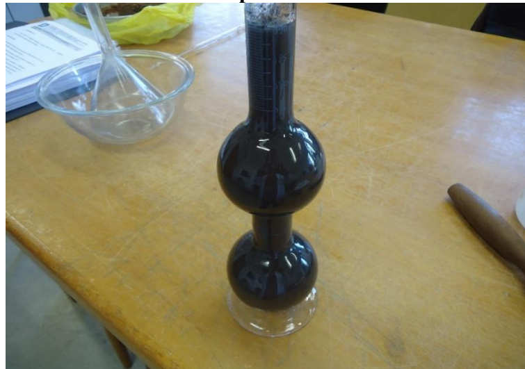
Figura 8 – Areia de descarte de fundição no frasco de Chapman para obtenção da massa específica.
