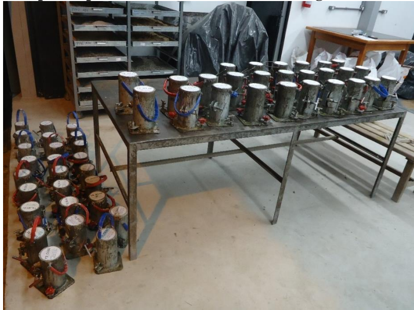
Figura 12 –Corpos de prova moldados e identificados aguardando a cura inicial.
