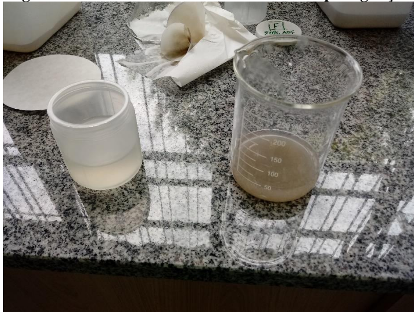
Figura 19 – Extrato lixiviado sendo filtrado após agitação.
