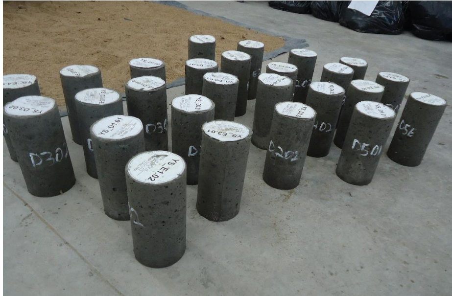
Figura 14 – Corpos de prova desmoldados e identificados prontos para a cura em imersão.
