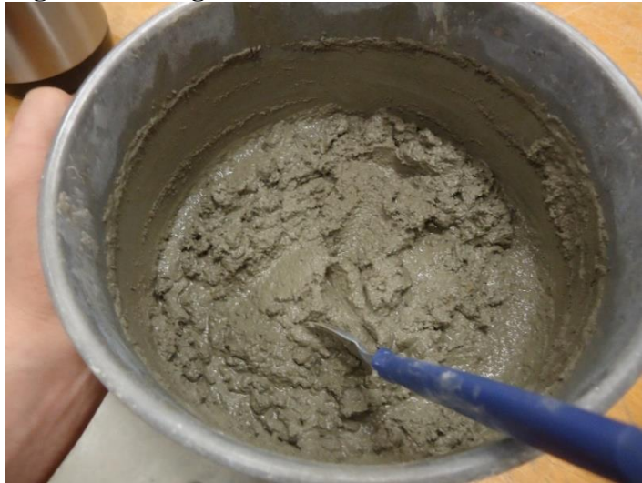
Figura 21 – Argamassa com 100% de areia natural.
