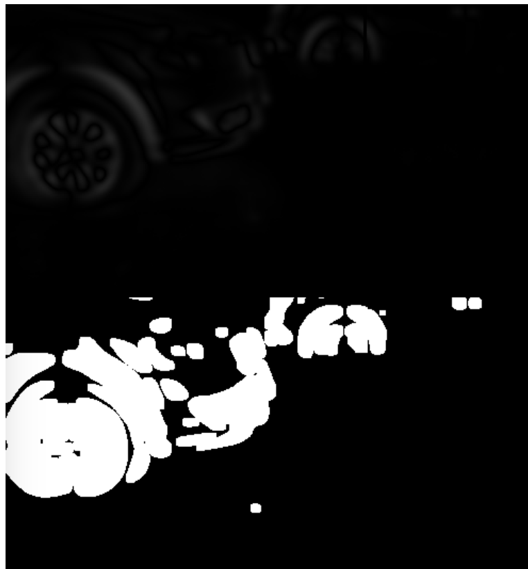
Figura 15 - Na parte superior, frame delta, na parte inferior, threshold do frame delta.
