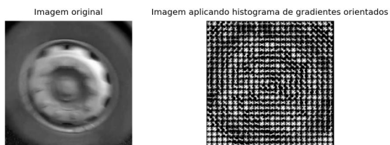
Figura 20 - Comparação entre imagem de um eixo de caminhão com o seu devido resultado após a aplicação do histograma de gradientes orientados.
