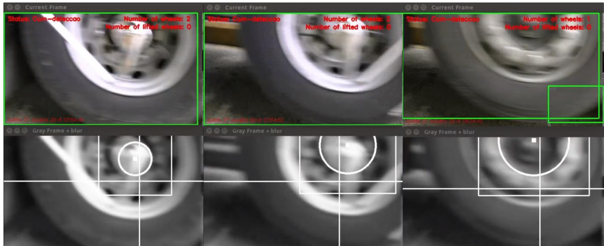
Figura 29 - Três círculos que não foram validados pelo classificador como sendo eixos válidos de um veículo.
