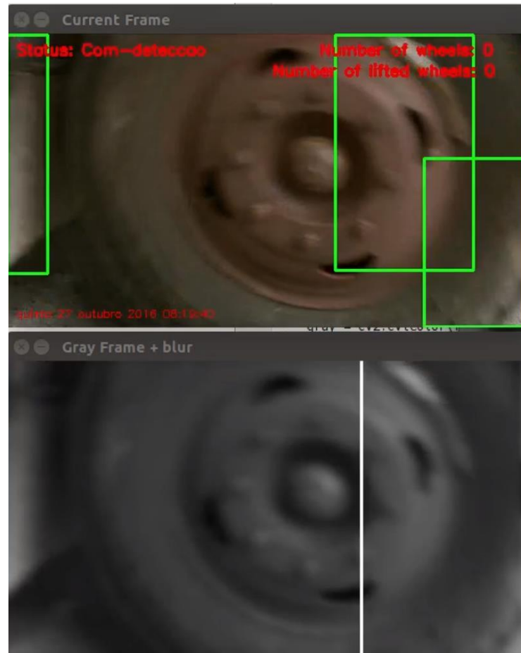
Figura 28 - Eixo onde os contornos detectados foram muito pequenos, não englobando todo o eixo do veículo.
