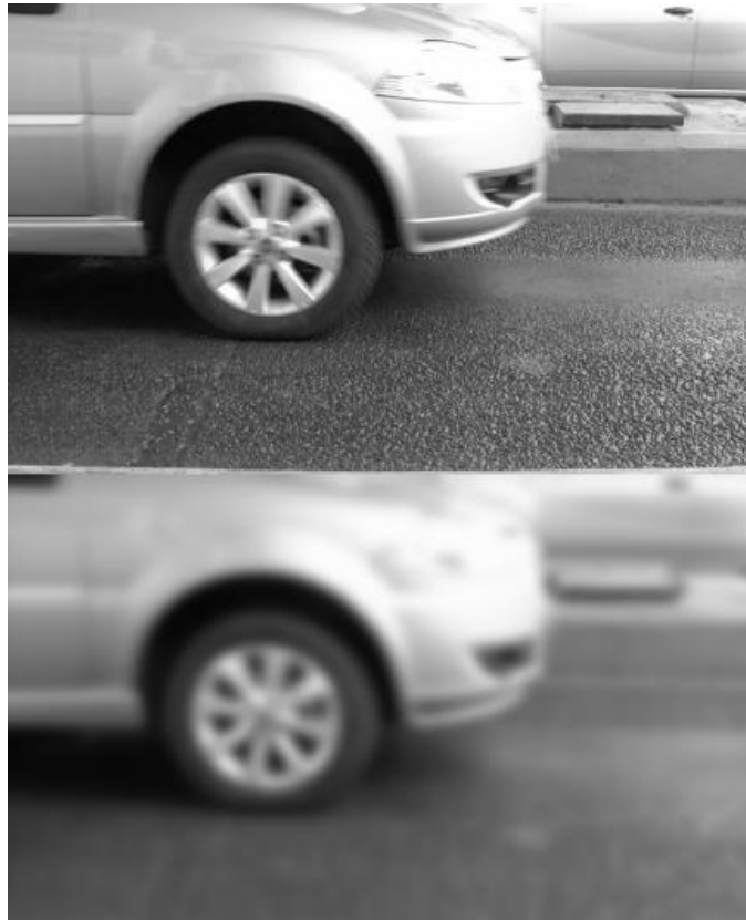
Figura 13 - Na parte superior, frame em escala cinza, na parte inferior, frame após a aplicação do filtro Gaussian Blur .
