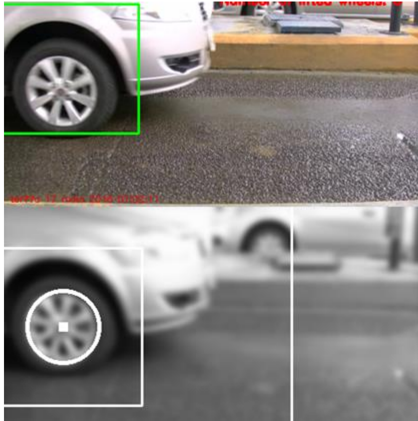
Figura 18 - Na parte superior, contorno detectado, na parte inferior, círculo detectado através da transformada de Hough .
