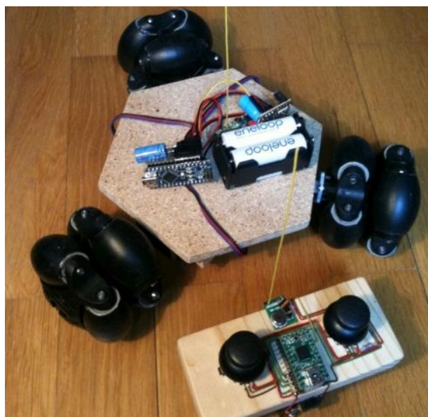
Figura 3: Exemplo de robô omnidirecional de três rodas. Fonte: (GRITSCH, 2011).
