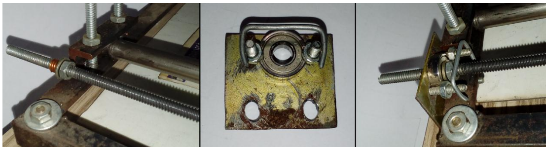
Imagem 27-Rolamento compensador para folga axial.
